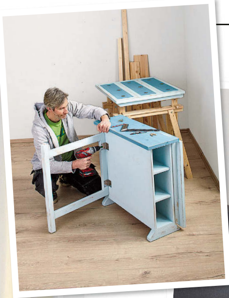
Der Schlüssel zur Flexibilität sind die Klappbeine mit Scharnier
