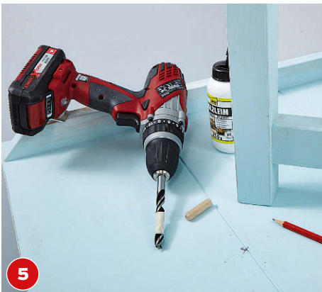
5 In der Unterseite der Tischplatten Löcher für die Arretierung bohren und die Holzdübel in der Platte verleimen.
