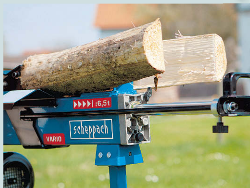
Umgekehrt: Nicht der Spaltkeil wird in das Holz gedrückt, sondern das Holz wird gegen den Keil gepresst
