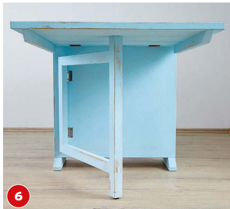
6 So kann die Tischplatte auf dem Klapprahmen ohne Gefahr des versehentlichen Verrückens sicher einrasten.
