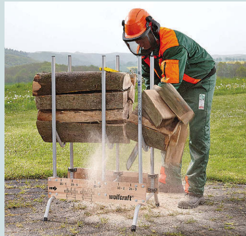
Schutzkleidung (Sichtschutz, Schnittschutzbekleidung sowie feste Schuhe) ist beim Arbeiten mit der Motorsäge unerlässlich
