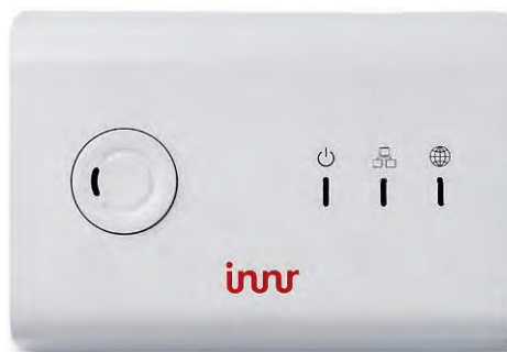
Die Innr-Bridge verbindet das Lichtsystem mit dem Router und der App
