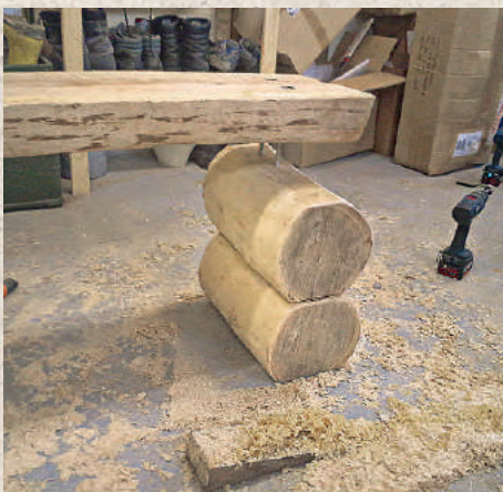
Nachdem die Füße auf die exakt gleiche Höhe gebracht wurden, kam die Sitzfläche – ein halbiertes Stamm – darauf
