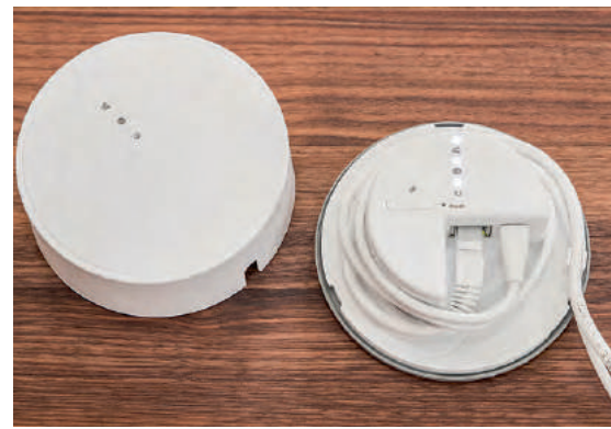
Mit dem Trådfri Hub, der Funkzentrale des Systems, steigt die Zahl steuerbarer Ikea-Lampen auf 100
