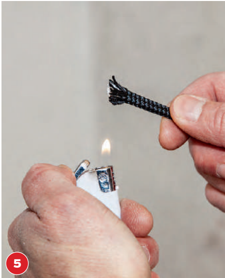
5 Die Enden der zugeschnittenen Seilstücke mit einem Feuerzeug verschmoren, so franzt nichts aus.
