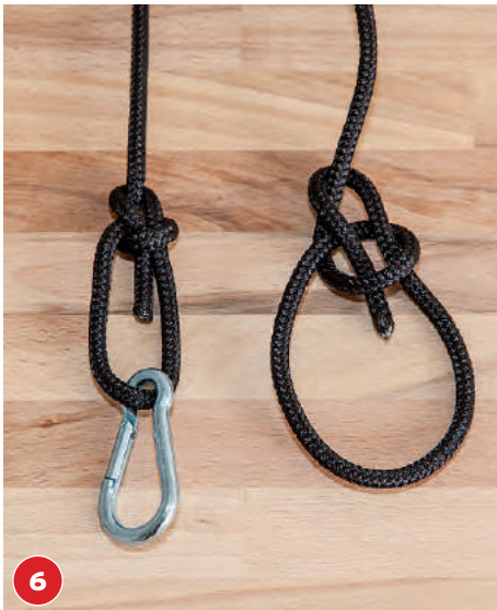
6 Als Knoten zum Befestigen der Karabinerhaken eignet sich der leicht wieder zu lösende Palstek am besten.
