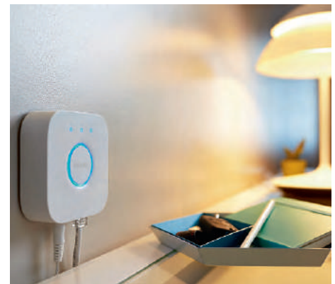
Bridge: Eine Funkbasis verbindet Zigbee-Lampen mit dem Heimnetzwerk. Sie ist Voraussetzung für die Bedienung per App
