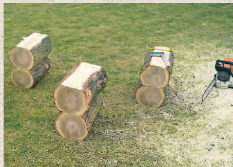
Die grobe Vorarbeit: Nach dem Fällen der Eiche wurden die einzelnen Bauteile mit der Kettensäge geformt
