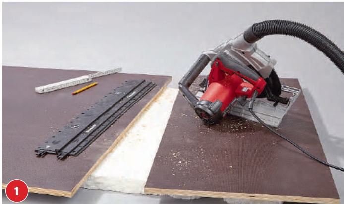
Die Siebdruckplatten sind mit einer Handkreissäge und einer Führungsschiene am einfachsten zuzuschneiden. Tipp: eine Styroporplatte beim Sägen unterlegen.
