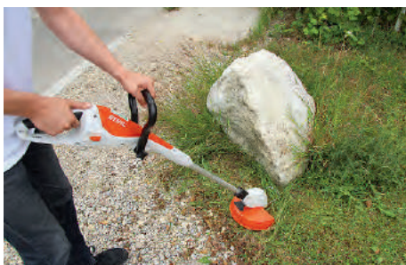
Der Metallbügel hält Abstand im Mähradius, so erwischt man keinen Stein oder Baumstamm
