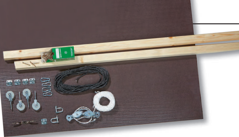
Das Material auf einen Blick: etwas Holz, vier Rollen, ein Seilzug, Karabiner und Seil
