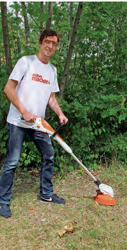
Der Dauertest: Nach etwa 15 Minuten Trimmen mit den Messern ist der Akku leer
