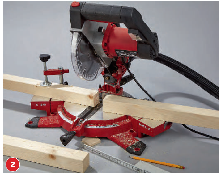
Die Kanthölzer für den Holzrahmen können Sie mit einer Kappsäge sauber und exakt zuschneiden. Mit einer Stichsäge oder Handsäge geht es natürlich auch.
