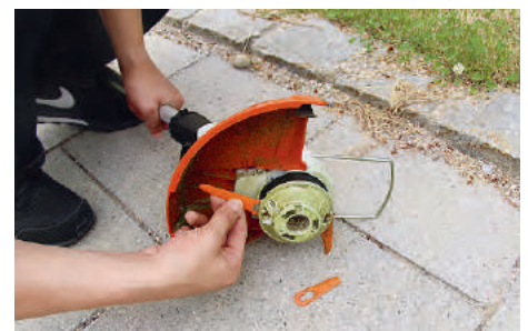
Der Wechsel der Kunststoffmesser funktioniert werkzeuglos: altes Messer herausdrücken und neues einstecken
