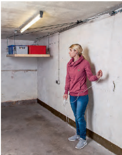
Dank des Flaschenzugs mit drei Rollen muss man nur noch einen Bruchteil des Gewichts ziehen.
