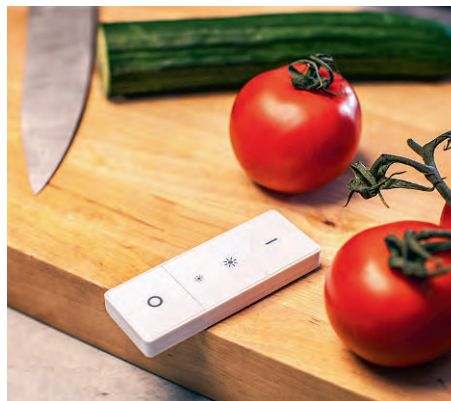
Fernbedienung: Zigbee-Lampen lassen sich auch ohne Bridge per Handsender steuern – allerdings mit eingeschränkter Funktion
