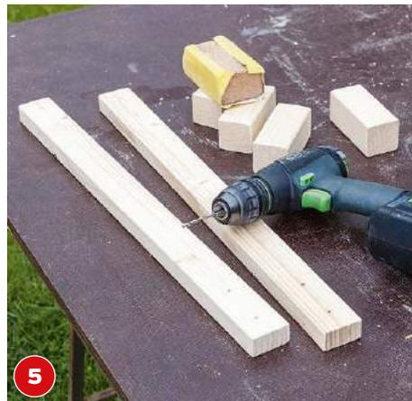
**5** Der Außenkorpus erhält Tragegriffe aus Rahmenholz (44 x 44 mm). Zusägen, mit dem Bohrer 4 mm vorbohren und schleifen.
