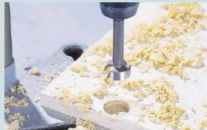
Mit dem Forstnerbohrer (26 oder 35 mm) im Bohrständer das Loch bis zur entsprechenden Tiefe vorbohren.
