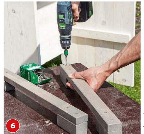
**6** Die langen und kurzen Teile der Tragegriffe verschrauben (4,5 x 50). Zuvor das Holz grau lasieren.
