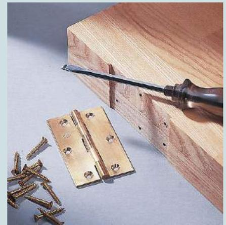
Sind die Aussparungen fertig, werden die Schraubenlöcher angezeichnet und in halber Stärke vorgebohrt.
