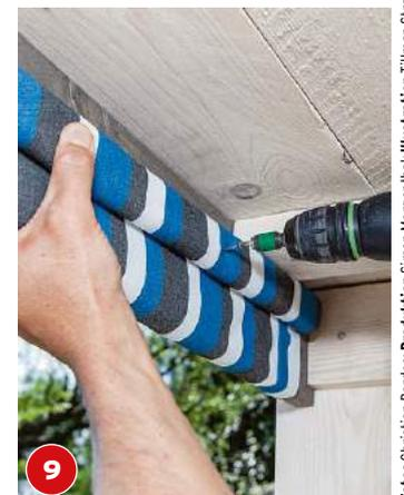
**9** Die Leiste gerade ausrichten und an der Innenseite der Blende verschrauben.
