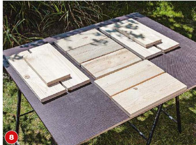
**8** Nun werden die Fußablagen zusammengeschrubt. Zunächst wieder die benötigten Teile nach Zuschnittplan anzeichnen und zusägen.
