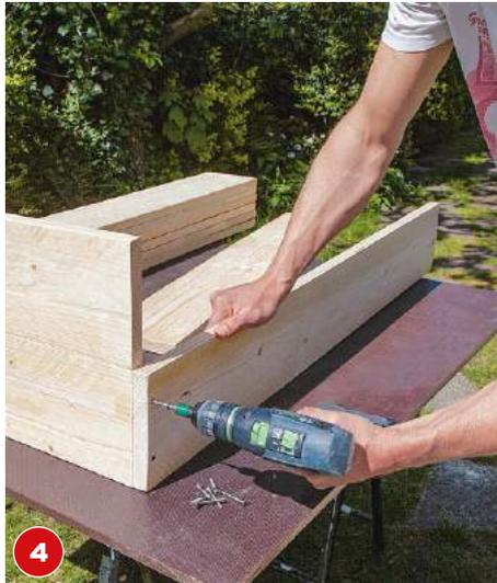
**4** Zunächst verschraubt man mit dem Akkuschrauber die vorbereitete Rückwand mit den beiden Außenseiten (4 x 50 mm).
