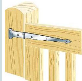
Werf- oder Kreuzgehange sind einfache Tor-scharnieren. Die Flugel des Scharniers, schmale Metallstreifen, sind fest miteinander verbunden und das Tor kann nicht ausgehangt werden.
