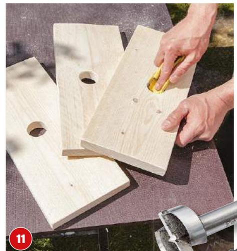
**11** Die Oberflächen der Bretter und Kanten der Bohrlöcher mit 80er-Korn schleifen.
