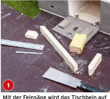
**1** Mit der Feinsäge wird das Tischbein auf die zuvor ermittelte Länge gekürzt und auf der Unterseite eingekeilt.
