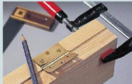
Für den zweiten Scharnierlappen das Scharnier provisorisch montieren und die exakte Position anzeichnen.
