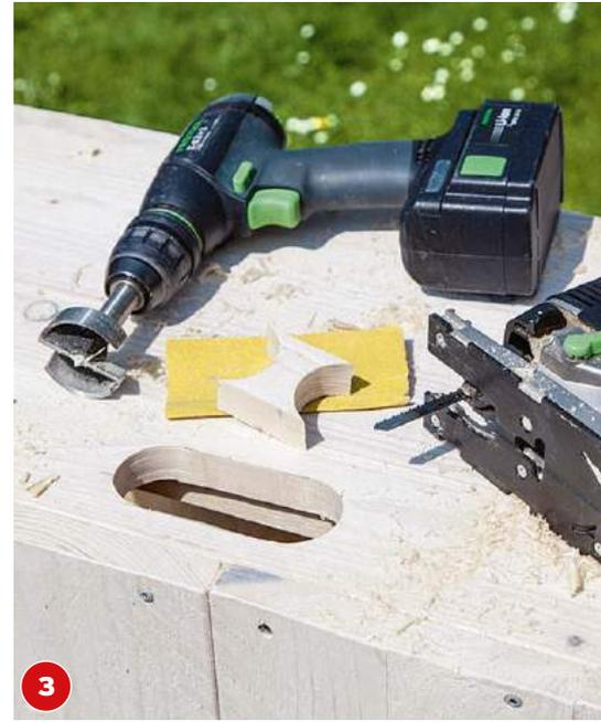
**3** Für die Trageöffnungen am Innenkorpus für die Trageöffnungen am Innenkorpus mit dem Forstnerbohrer (50 mm) Löcher bohren, dann den Steg durchsägen.
