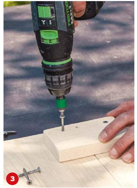
**3** Die beiden Teile des mittig angebrachten Klappptisches werden mit zwei Verbindungsklötzen verschraubt.
