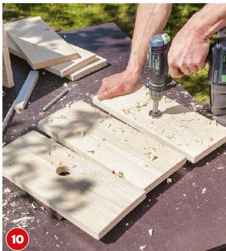
**10** In die Fronten der Fußkästen bohrt man mit dem Forstnerbohrer Grifflöcher mit jeweils 40 mm Durchmesser
