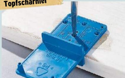
Mit einer Einbohrschablone wird der Bohrlochabstand zur Vorderkante mit einem Vorstecher (Dorn) markiert.
