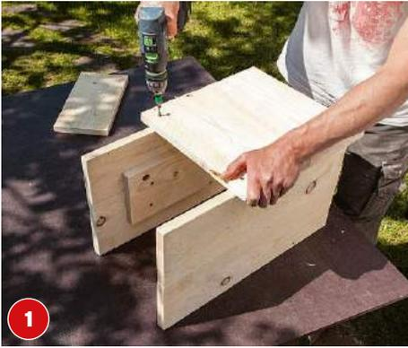
**1** Die Deckel der beiden Fußablagen werden jeweils mit Schrauben 4 x 50 mm auf den Seitenteilen befestigt.
