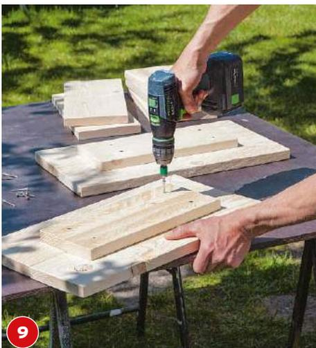
**9** Mit der bewährten Methode der Verbindungsbretter werden die Außenseiten verschraubt (4,5 x 40 mm).
