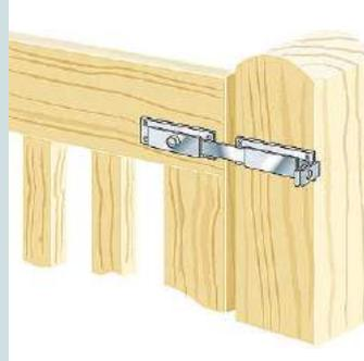
Sogenannte Doppelturuberfallen sind praktisch, da man sie leicht mit Schlossern sichern kann. Die Verschraubungen sind dabei durch den Riegel verdeckt.
