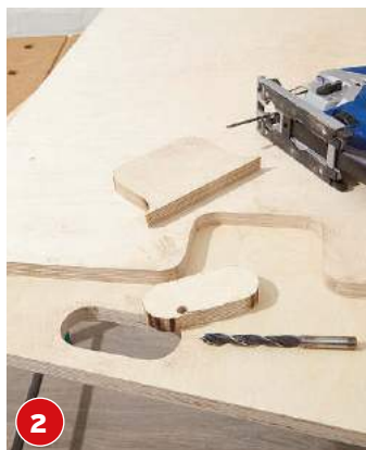
2 Für alle geschwungenen Ausschnitte setzen Sie ein Kurvensägeblatt in die Stichsäge ein.
