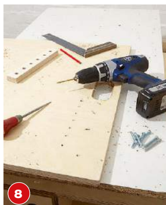
8 Bohren Sie die Löcher für die Aufhängungen und für das Schraubendreher-Display sauber vor.
