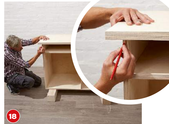
18 Die Arbeitsplatte ist rechtsbündig, links hat sie einen Überstand. Die Platte auflegen, ausrichten und markieren.
