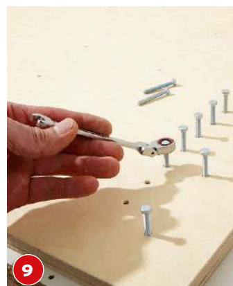
9 Holzschrauben mit Sechskantkopf für die Werkzeugaufnahme eindrehen.
