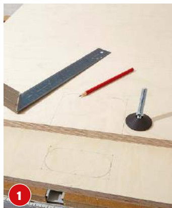
1 Zeichnen Sie die Griffposition an der Oberseite der Platte an. Runden Sie die Ränder aus.
