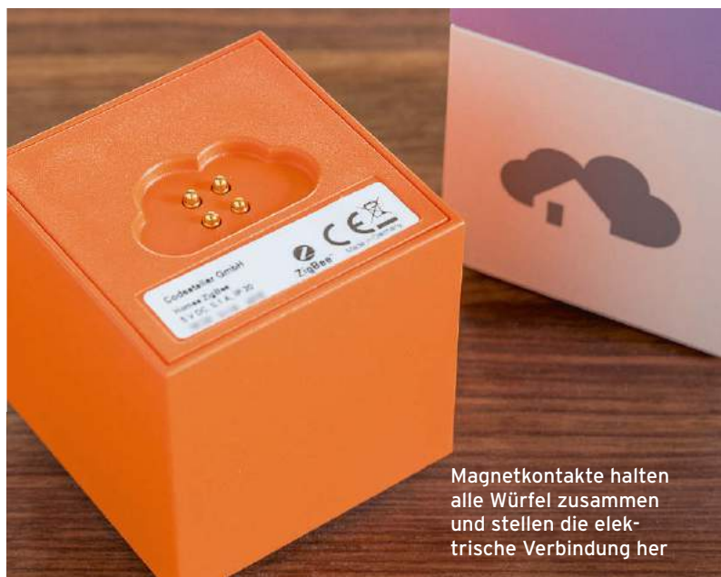
Der Brain Cube versorgt die komplette Homee-Zentrale mit Energie. Außer fürs Netzteil gibt es keine Anschlüsse
