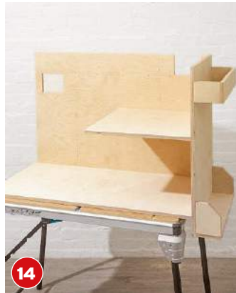
14 Das Zwischenboard wird mit Schrauben an Rück- und Seitenwand fixiert.
