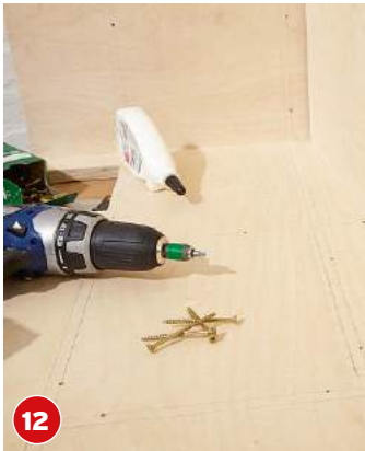
12 Bevor Sie die Rückwand montieren, markieren Sie den Verlauf des Schubkastens.
