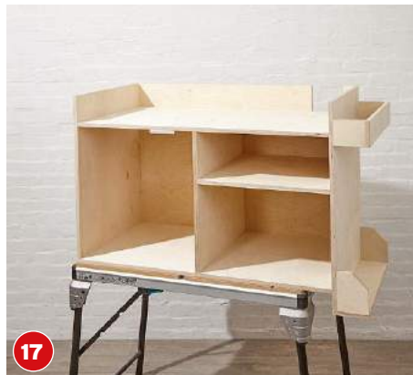
17 Durch die zweite Seitenwand bekommt der Zwischenboden seine endgültige Stabilität. Die Öffnungsmaße kontrollieren!
