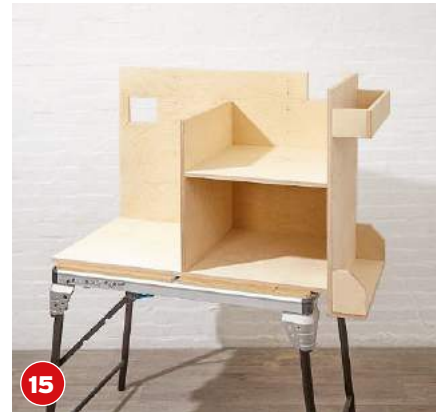
15 Es folgt die Seite des Schubkastens. Durch das Vorbohren wird es genau.
