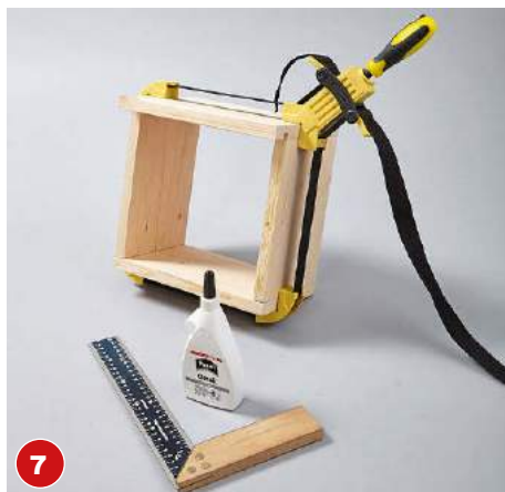
7 Eine Hilfe beim Fixieren sind Bandzwingen. In diesem Fall verwenden Sie normalen Holzleim. Von Stanley, um 20 Euro.
