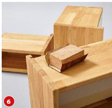
6 Ist das Öl angetrocknet, werden die Flächen mit feinem Schleifpapier (280er- oder 320er-Korn) zwischengeschleift.
