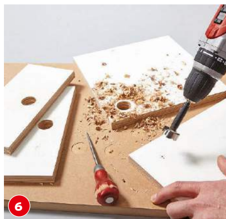
6 Die Grifflöcher für Schubladen und Schiebetüren markieren, vorstechen und mit einem 30-mm-Forstnerbohrer bohren.
