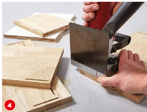
4 Mit der Fräse die Positionen für Dübel (20 mm) fräsen. Dabei die gewählte Anschlagposition (rote Markierung) merken und beim passenden Teil analog anwenden.
