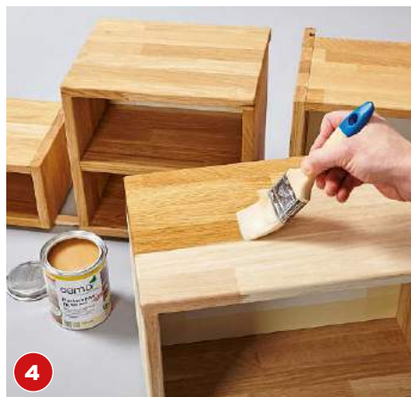
4 Die Flächen sorgfältig vom Schleifstaub befreien und mit einem Pinsel das Hartwachs-Öl auftragen.
