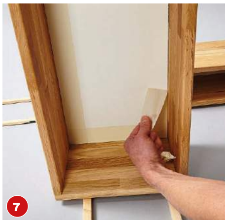
7 Nach dem erneuten Ölen und Abtrocknen zieht man das schützende Kreppband von der Rückseite ab.
