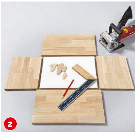
2 Die Positionen der Flachdübel zeichnen Sie mit dem Schreinerwinkel an den jeweils zugehörigen Seiten an.
