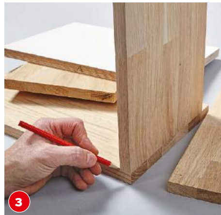
3 An den überstehenden Deckeln muss die Anschlaglinie für die Flachdübelfräse etwa 3 cm vom Rand angezeichnet werden.
