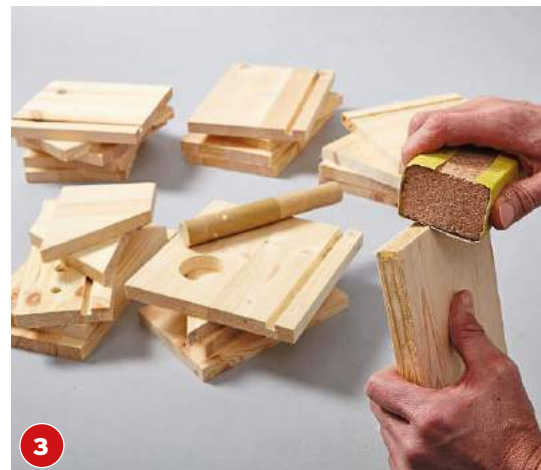
3 Im Anschluss schleifen Sie alle Kanten der Korpusteile mit einem Schleifklotz und Schleifpapier mit 120er-Korn.
