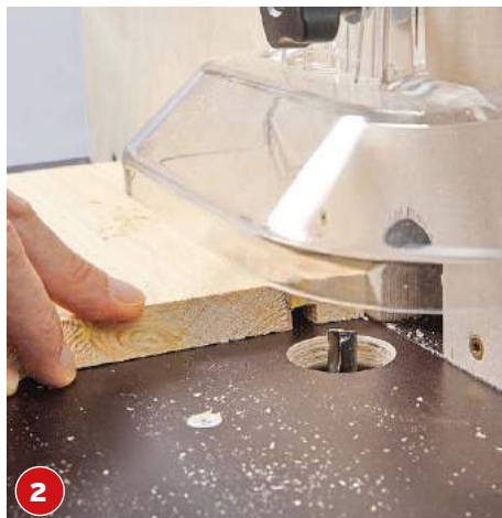
2 In die Deckelteile wird mit der Oberfräse eine Nut gefräst (10 mm), um sie später an der Falz der Schienen einzuhängen.
