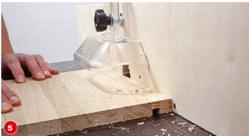
5 Die Deckelteile werden mit einer Nut versehen, um das Element später an die Falz der Wandschienen zu hängen. Dafür fräsen Sie eine Nut mit einem 10-mm-Fräser. Der Abstand zur Kante muss auf den der Falz abgestimmt sein.
