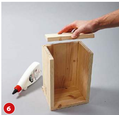
6 Zum Schluss wird der Boden an die Stirnseiten der Seitenteile geleimt. Nach Anweisung des Herstellers trocknen lassen.
