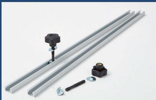
**Führungsschienen** aus eloxiertem Aluminium sind in verschiedenen Längen erhältlich, je nach Arbeitsbereich und Größe des Frästisches. Zur Fixierung des Parallelanschlags (Schiene sitzt unter der Platte) wird sie mit T-Nutenstein, Gewindestift und Sterngriff kombiniert
