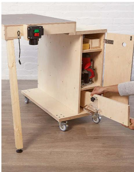
**Der Parallelanschlag** wird mit montierter Absaughaube und dem rückwärtigen Staubkasten im unteren Staufach geparkt
