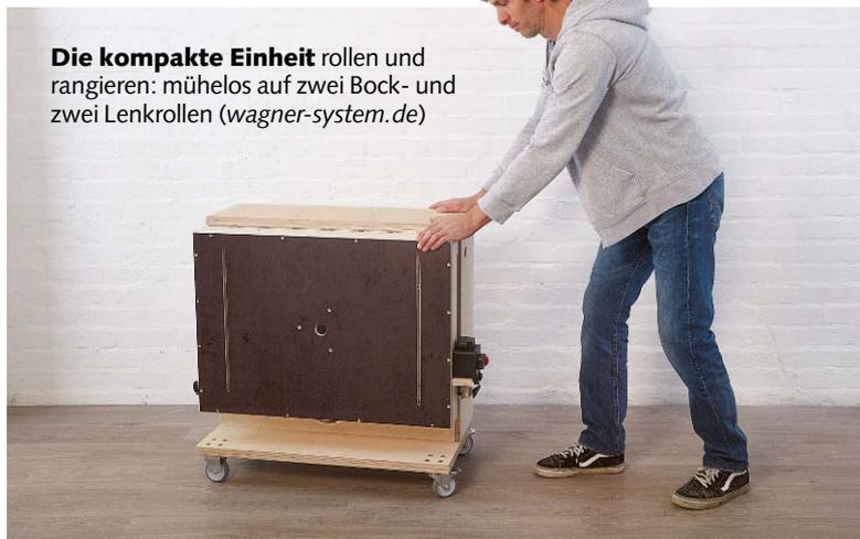
**Die kompakte Einheit** rollen und rangieren: mühelos auf zwei Bock- und zwei Lenkrollen ([wagner-system.de](http://wagner-system.de))
