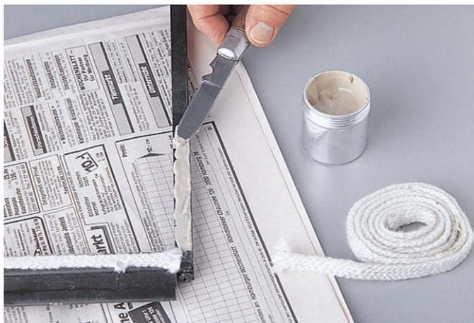
Wenn die Kaminofentür nicht mehr richtig schließt, liegt es meist an der Dichtung. Sie besteht aus einer speziellen Dichtschnur, die mit den Jahren ihre Wirkung verliert. Dann muss man sie entfernen und eine neue Dichtung mit einem hitzebeständigen Dichtschnurkleber einsetzen. Schnur und Kleber bekommen Sie in gut sortierten Baumärkten und im Ofenhandel. Eine große Auswahl gibt es auch im Internet, beispielsweise unter [www.ofendichtung.de](http://www.ofendichtung.de).
