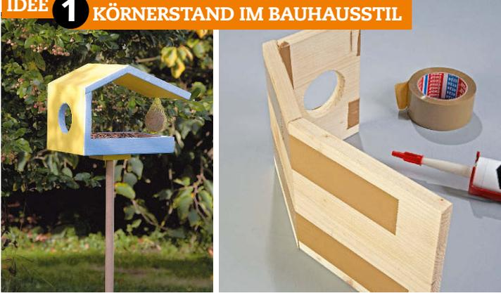
In städtischer Umgebung kommt das kleine Kunstwerk so richtig zur Geltung. Mit der Stichsäge werden neben dem Boden auch die Dachteile zurechtgesägt: auf Gehrung und in einem Winkel von 75 Grad. Per Lochsäge kommt ein runder Ausschnitt in das Seitenteil.
