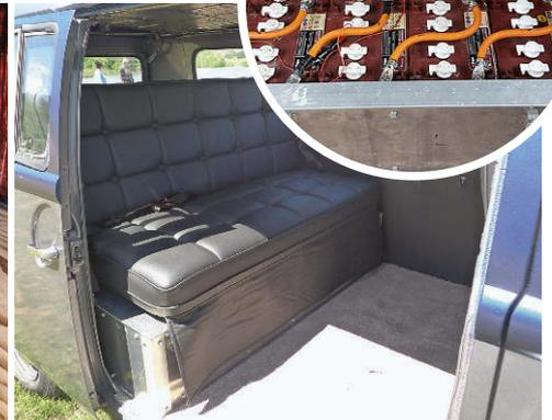
**Der Stromspeicher:** Unter der neuen Sitzbank sind insgesamt zwölf Blockbatterien mit je 150 Amperestunden Kapazität untergebracht.
