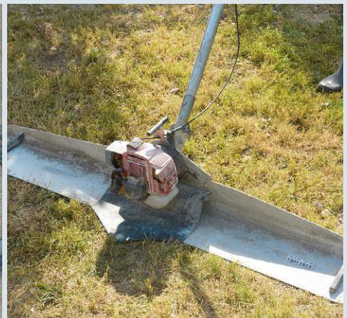
**Mit der Rüttelpatsche** ziehen Sie schnell und mühelos frische Betonflächen ab. Sie gewährleistet eine optimale Oberflächenverdichtung
