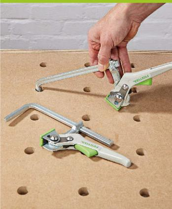
**Die Hebelzwingen** lassen sich in 20-mm-Löchern auf der ganzen Werkbank-Fläche einsetzen
