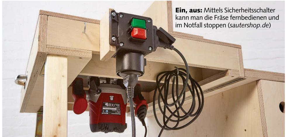
Ein, aus: Mittels Sicherheitsschalter kann man die Fräse fernbedienen und im Notfall stoppen ([sautershop.de](http://sautershop.de))
