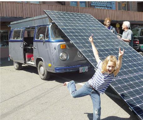
**Auf einem selbst konstruierten Metallrahmen** finden die vier Photovoltaik-Module auf dem Dach des Busses Platz
