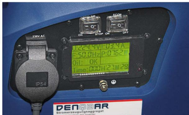
**Das gut lesbare Display** zeigt den Ölstand, die aktuellen Leistungsdaten, die Laufzeit sowie eine mögliche Überlastung an
