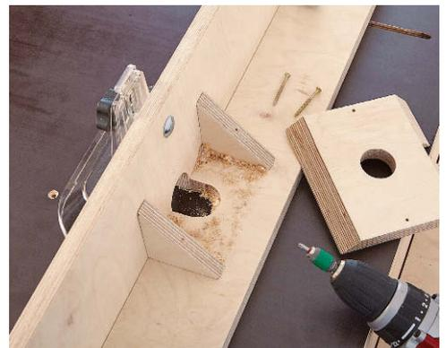
Die Abdeckung wird nur durch Holzschrauben gesichert. So bleibt der Absaugkanal bei Bedarf (Verstopfung durch Späne) jederzeit zugänglich
