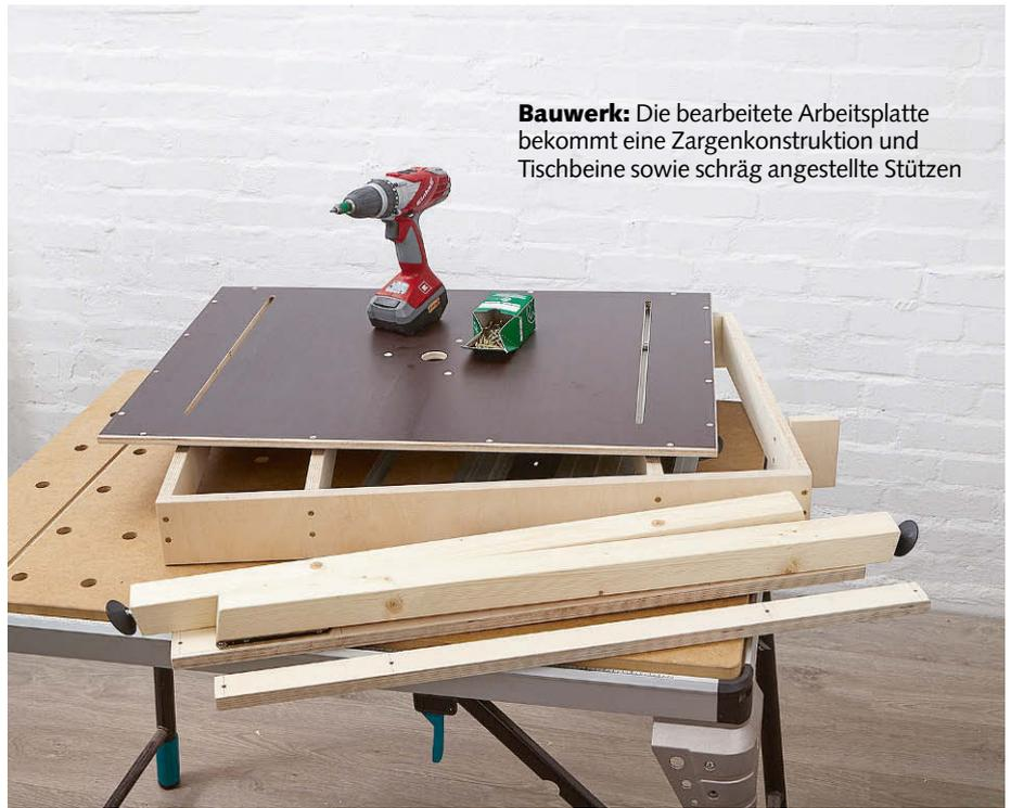
**Bauwerk:** Die bearbeitete Arbeitsplatte bekommt eine Zargenkonstruktion und Tischbeine sowie schräg angestellte Stützen
