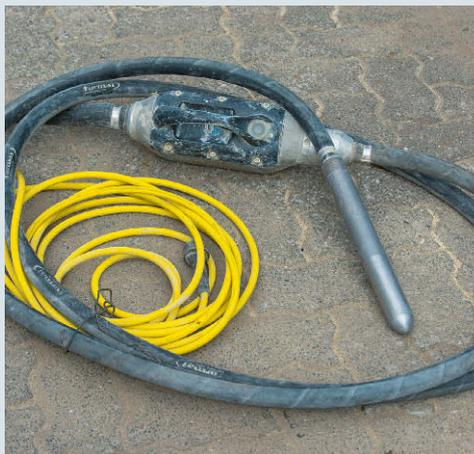
**Elektronische Betoninnenrüttler** fördern durch Vibration Lufteinschlüsse im fließfähig eingebauten Beton an die Oberfläche
