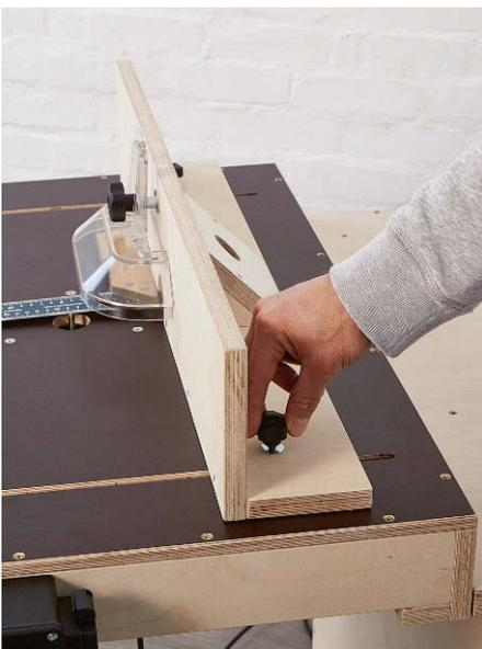
**Zwei Knebelschrauben** sichern den Anschlag in der gewählten Arbeitsposition. Zum Verstauen die Schrauben komplett lösen
