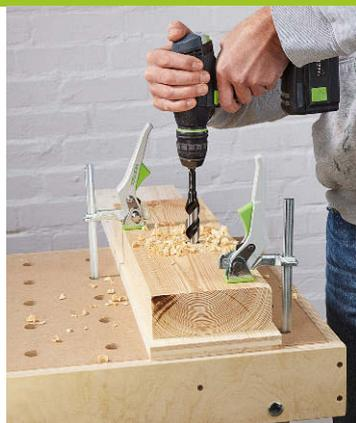
**Dank der Rasterung** löst sich die Feststellung auch bei vibrationsstarken Arbeiten nicht
