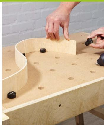
**Mit den kleinen Anschlätzen** können Sie unregelmäßig geformte Werkstücke perfekt einspannen
