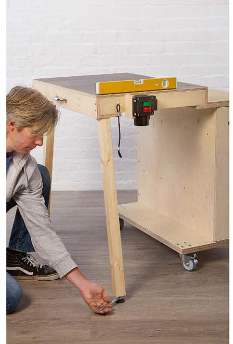
Stellfüße mit metrischem Gewinde gleichen Bodenebenheiten aus und sichern den ebenen, wackelfreien Stand auf dem Boden
