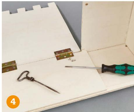
**4** Eine Sperrholzplatte als Zulage auf den Torboden leimen, damit die Brücke 90° öffnet. Die Montagepunkte der Scharniere vorpieken.
