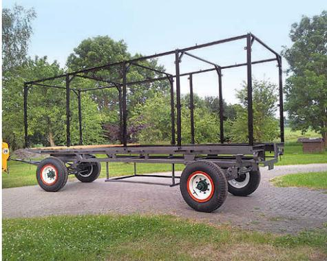
**Das aufgearbeitete Grundgerüst:** Durchrostete Träger wurden herausgeflext und neu eingeschweißt, sogar die Felgen wurden überholt.
