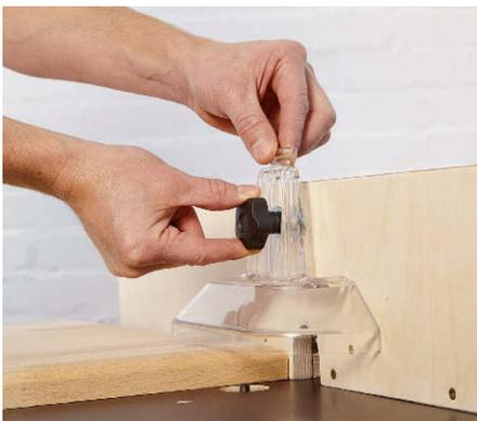
Durchblick: Eine transparente Abzugshaube ([sautershop.de](http://sautershop.de)) hilft, den Staub abzunehmen. Montage mittels Feststellschraube mit Knebel
