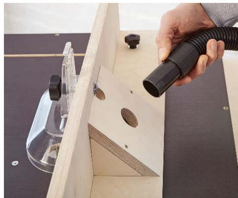
Eine Bohrung mit 35 mm Durchmesser in der Abdeckung bildet die passgenaue Aufnahme für den Stutzen des Werkstattsaugers
