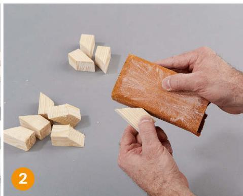
**2** Die rauen Sägekanten werden mit 120er-Schleifpapier geglättet. Ein Schleifklotz garantiert einen gleichmäßigen Kantenschliff.
