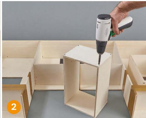
**2** Die Fensterfächer werden ebenso verleimt und verschraubt. Dabei die Schrauben genau mittig in die Schnittkanten setzen!
