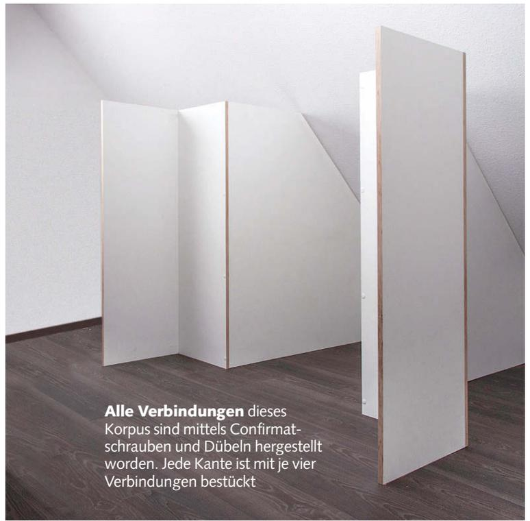
Alle Verbindungen dieses Korpus sind mittels Confirmat-Schrauben und Dübeln hergestellt worden. Jede Kante ist mit je vier Verbindungen bestückt
