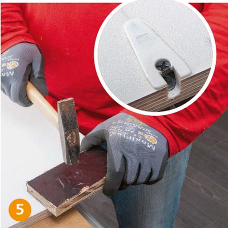
Den Beschlag vorsichtig mit einem Hammer und einer Vorlage einschlagen, so dass er bündig zu allen Seiten abschließt.
