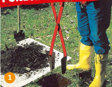
**1** Klappspaten (Handbagger) erleichtern das Ausheben enger, bis zu 90 cm tiefer Löcher. Sie funktionieren wie eine Zange, die die Erde greift und nach oben befördert.
