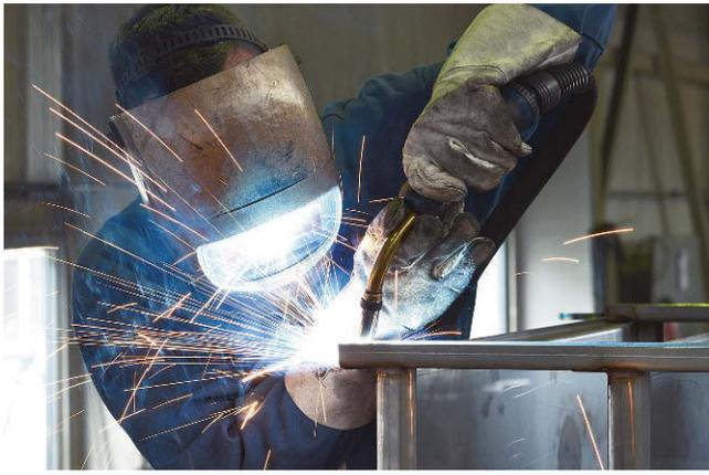
**Da das Schweißen** so gut wie immer mit starken Strömen oder explosiven Gasen, giftigen Abgasen, gefährlicher Licht- und Wärmeentwicklung sowie Spritzern flüssigen Metalls verbunden ist, müssen hier eine Vielzahl an Schutzmaßnahmen getroffen werden: Eine Schweißmaske und Handschuhe sowie feuerfeste Kleidung sind angesagt
