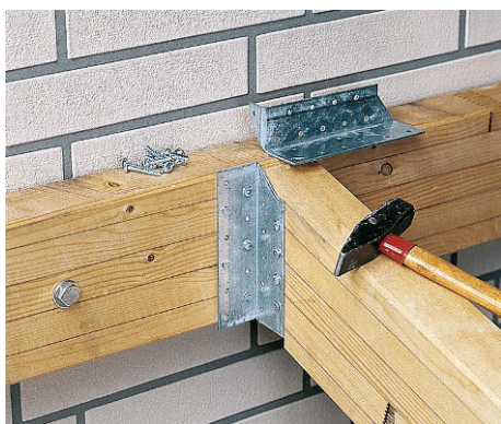
Vario-Balkenschuhe bestehen aus zwei Teilen und lassen sich für Balken jeder Breite verwenden. Man kann sie wahlweise zuerst an den Balken oder die Wand schrauben
