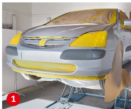
1 Fenster, Türen, Lichter und alles, was keine neue Farbe bekommen soll, gründlich abkleben. Kein Malerkrepp verwenden! Von Foliatic gibt es Spezial-Zubehör.
