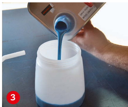
3 Beim Befüllen des Sprühbehälters auf die Maximalbefüllung achten! Ggf. Sprühfolie nach Herstellerangaben ver- dünnen. Nachfüllen ist jederzeit möglich.
