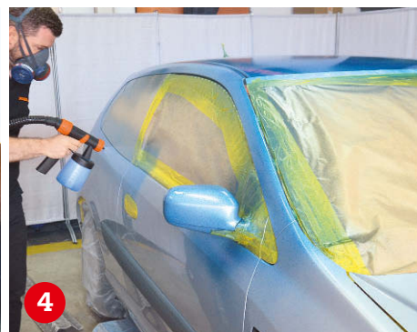
4 Das Sprühverhalten an einem Karton testen. Sprühpistole nach Herstellerangabe ein- stellen. Im Abstand von 30 bis 40 cm die erste Lage der Sprühfolie gleichmäßig auftragen.
