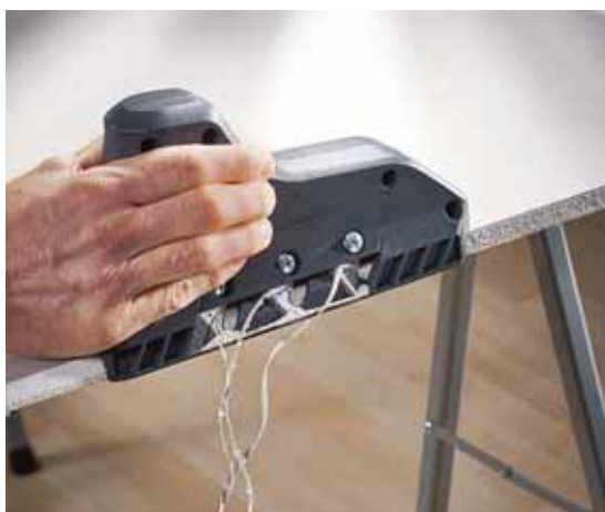
Die drei Klingen schneiden nur wenig Gips weg. Sie werden geschont und bleiben lange scharf
