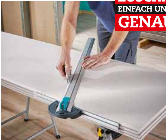
Gerade bei Serienschneiden im gleichbleibenden Winkel ist die Reißschiene ideal
