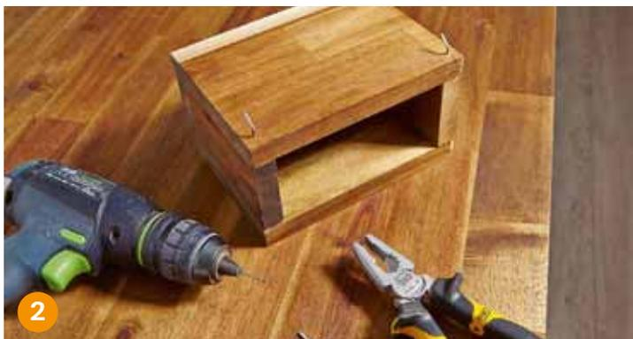
Die **Teile für die Stiftebox** werden ebenfalls stumpf miteinander verleimt. Mit Metallhaken an der Rückseite werden die Ordnungshelfer später in die Lochblechwand eingehängt.
