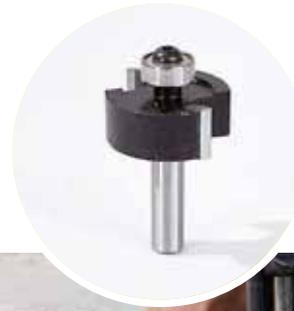
Die **Oberfräse** haben wir mit einem Falzfräser mit 31,7 mm Durchmesser versehen. Die Falztiefe ist durch Austausch des Kugellagers variabel
