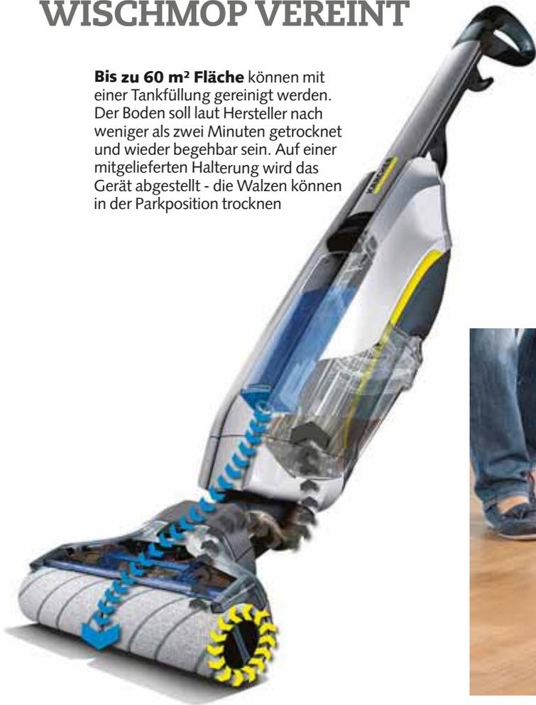
**Reiner Trimmer:** Kärcher hat mit dem „FC 5“ ein Gerät entwickelt, das Saugen und Wischen in einem Arbeitsschritt erledigt. Zwei Mikrofaserwalzen werden aus einem 400-ml-Tank ständig mit Wasser oder Reinigungslösung befeuchtet. Angetrockneter Schmutz wird zusammen mit Staub aufgenommen. Der Schmutz wird anschließend von der Oberseite der Walzen abgesaugt. Die Reinigungslösung wird in einen zweiten Schmutzwassertank geleitet. Ab 2017 erhältlich.
