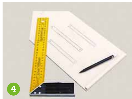
Die drei Einflugschlitze mit einem Bleistift zehn Millimeter breit und etwa 15 Zentimeter hoch anzeichnen.
