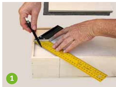
An der Seite , an die der Deckel zugeschoben wird, den Mittelpunkt messen. Von dort auf Vorder- und Rückseite 45°-Winkel anzeichnen.
