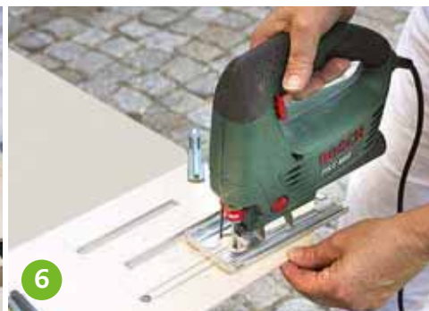
Mit der Stichsäge an den vorgezeichneten Schnittlinien zwischen den Löchern entlang sägen. Dann die Kanten mit Schleifpapier glätten.
