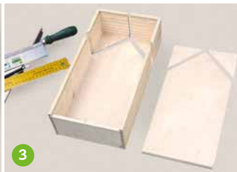
Nach dem Sägen wird der Deckel gelöst und aus der Kiste gezogen. Nun sind die Dachschrägen des Häuschens fertiggestellt.
