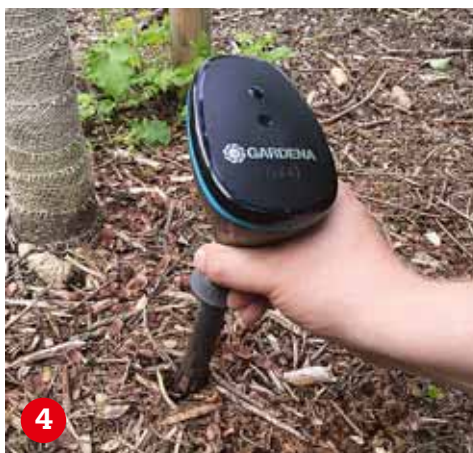
4 Den Bodensensor ebenfalls mit Batterien ausstatten, in den Boden stecken und per App hinzufügen.
