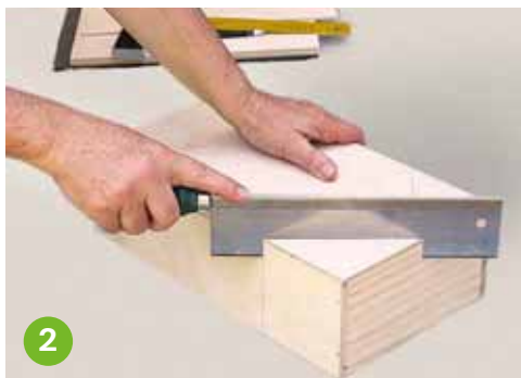
Den Schiebedeckel mit Zwinge oder Paketband im Kistenkorpus festsetzen und die Ecken der Kiste entlang der Markierungen absägen.
