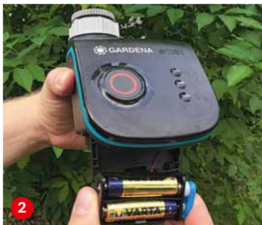
2 Die Bewässerungssteuerung und der Bodensensor werden mit Batterien betrieben, die eine Saison halten sollen – im Test deutlich kürzer (1,5 Wochen).
