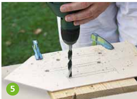
Zum Ausschneiden mit der Stichsäge jeweils an beiden Enden der Schlitze mit einem 10er-Holzbohrer vorbohren.
