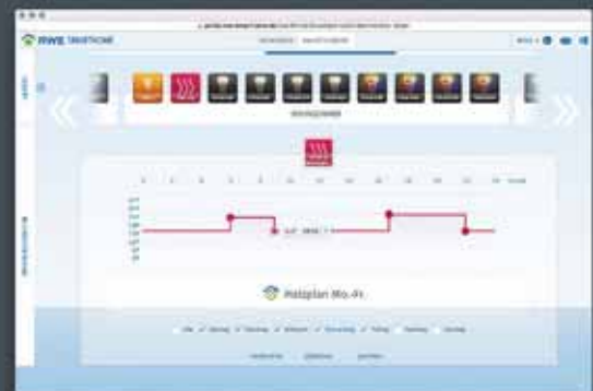
Teamarbeit: Thermostate, die dem selben Raum zugewiesen sind, verbinden sich zu einer Gruppe und folgen einem gemeinsamen Temperaturverlauf
