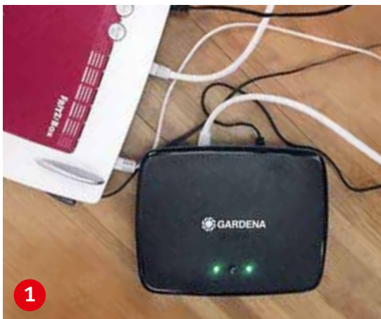
1 Gardena Gateway am besten mit Netzwerkkabel an den Router anschließen. Später ist auch eine WLAN-Verbindung möglich.
