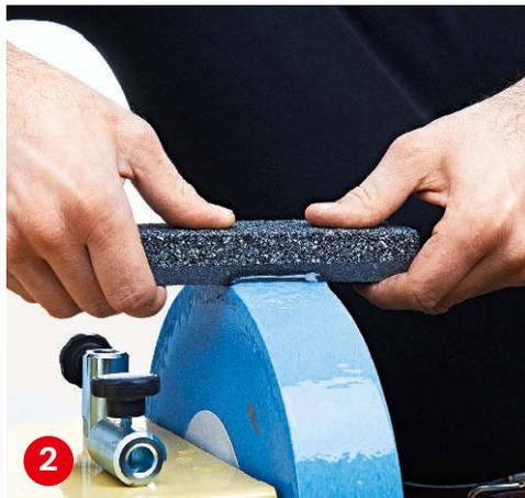
**2** Den **Steinpräparierer** pressen Sie etwa 20 Sekunden lang gegen den Schleifstein und stellen ihn so auf Körnung 1.000 ein. Führen Sie dann den Feinschliff der Klinge durch.
