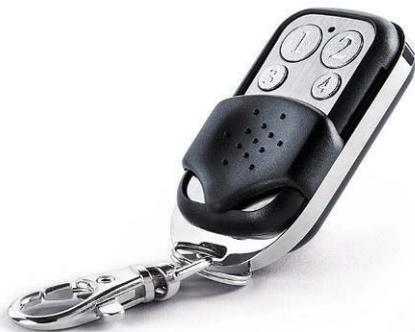
**Fernbedienung:** Der kleine Z-Wave-Sender (40 Euro) passt an den Schlüsselbund. Seine vier Tasten lassen sich mit beliebigen Funktionen im Smarthome belegen
