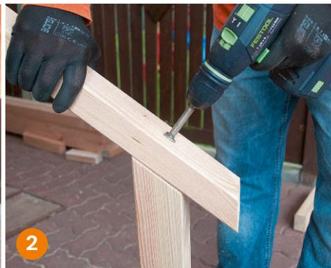
**Mit dem Forstnerbohrer** bereiten Sie die Sacklöcher für die Schraubverbindungen vor. Diese werden später verschleift.
