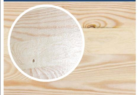
Auf Nitrozellulose basierende Versiegelung, geeignet für normal beanspruchte Möbel. Nicht matt, sondern seidig bis stark glänzend. Eine Oberfläche ist flux fertig, schnell überarbeitet, aber nicht besonders wasserfest.
