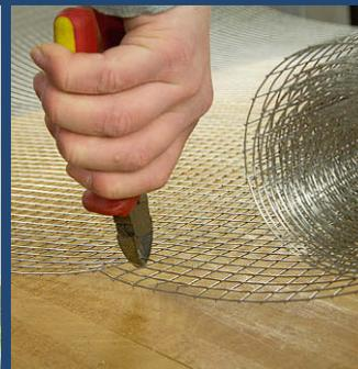
**Volierendraht aus V2A-Edelstahl** ist rostfrei und muss daher nicht extra beschichtet oder lackiert werden.
