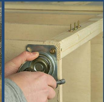
**Bockrollen**, unter die Voliere geschraubt, erleichtern das Umstellen. Ob zum Reinigen oder für einen Standortwechsel.
