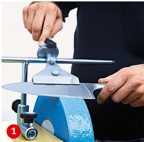
**1** Die **Klemmvorrichtung** an der Universalstütze hält die Klinge in Position. So lange mit 220er Körnung schleifen, bis auf der ganzen Schneide ein spürbarer Grat entsteht.
