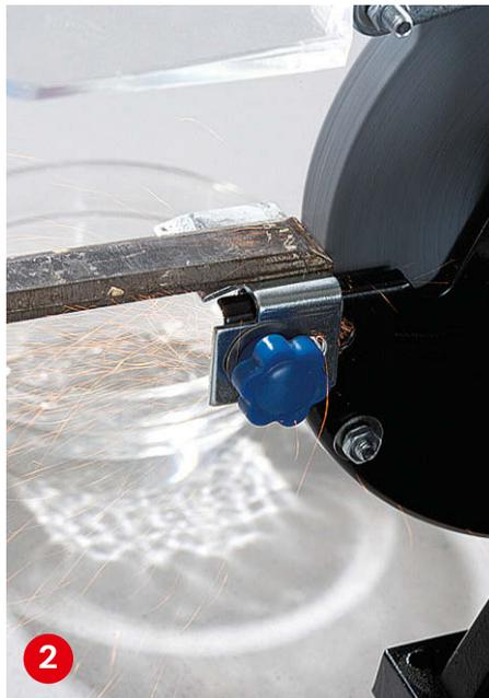
**Führen Sie das Eisen** mit Spiegel nach unten fast waagrecht an den Schleifstein, um die groben Scharten wegzuschleifen.
