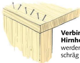
**Verbindung im Hirnholz:** Die Nägel werden wechselseitig schräg eingeschlagen
