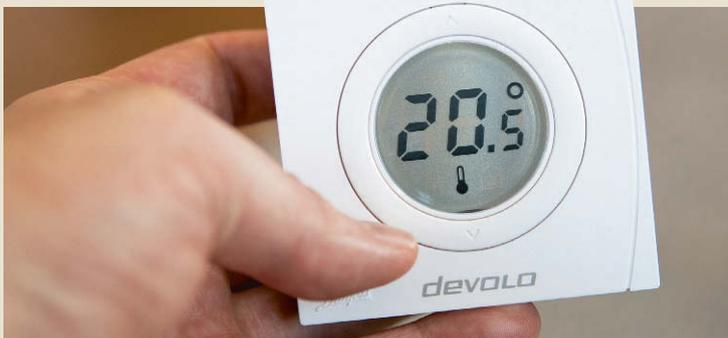
**Raumthermostat:** Der drahtlose Temperaturfühler für die Wand (100 Euro) steuert mehrere Heizkörperregler auf einmal
