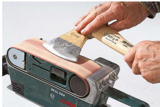
**Zum Schärfen einer Axt** brauchen Sie nicht unbedingt eine Schleifmaschine, das funktioniert auch mit einem umgedrehten und fixierten Bandschleifer.
