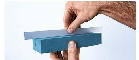
**Die Ebenheit** überprüfen Sie bei Gegenlicht mit einer geraden Aluminiumleiste.
