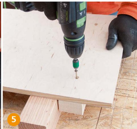
**5** **Die Latte verschrauben Sie** zusätzlich durch die Vorderseite. Zuvor das Vorbohren und Ansenken nicht vergessen.
