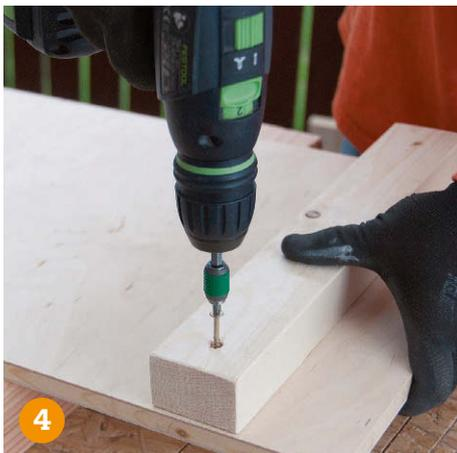
**4** **Für die beschriftbare Tafel** verschrauben Sie auf der Rückseite der zugeschnittenen Tischlerplatte zwei Befestigungslatten.
