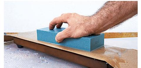
**Angefeuchtetes, wasserfestes Schleifpapier** auf eine Glasplatte legen und mit einer Hand festhalten. Mit der anderen Hand den Schärfstein so lange über das Schleifpapier schieben, bis die Oberfläche wieder gerade ist.
