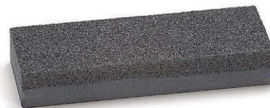
Mit einem **Steinpräparierer** kann man den Schleifstein des Nassschleifers auf Feinschliff einstellen. Kosten: ab 23 Euro
