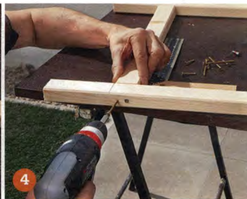
Entsprechend der Maße der Matte den Rahmen zusammenbauen. Dazu die Zwischenleisten mit zwei Schrauben je Seite befestigen.
