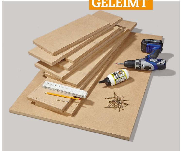
**Das Material für das Seitenregal:** Beachten Sie beim Zuschneiden, dass die Rückwand nicht aufgesetzt wird, sondern von den vier Rahmenbrettern umschlossen wird. Die inneren Bretter sind entsprechend weniger tief. Die Schrauben des Regals messen jeweils 3,5 x 50 mm.
