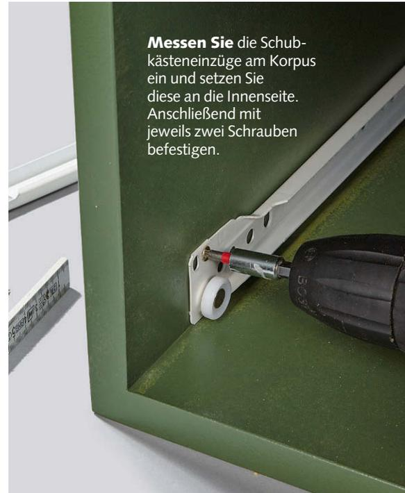
**Messen Sie** die Schubkästeneinzüge am Korpus ein und setzen Sie diese an die Innenseite. Anschließend mit jeweils zwei Schrauben befestigen.
