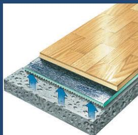
**Praktisch:** Laminatdielen mit integrierter Dämmunterlage und Feuchtigkeitsschutz ersparen einem viel Arbeit
