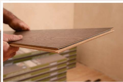
Hochwertige Laminatdielen bieten eine Kopfkanntenverriegelung an. Dabei handelt es sich um eine kleine Kunststofffeder an einer der Stirnseiten. Wird die nächste Diele von oben nach unten eingeschwenkt, drückt sie die Feder nach hinten in die Trägerplatte. Sind beide Dielen auf einer Höhe, schnellt die Feder in die Nut der nächsten. **Top:** Sie müssen die Dielen nicht mehr mit Hammer und Schlagklotz zusammentreiben
