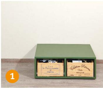
**Das Zweiermodul** nimmt zwei Weinkisten auf, die als Schubfächer nach vorne herausgezogen werden können. Nach oben sind fünf Zentimeter Luft, um die Kisten bequem herauszuziehen. Bei der Variante mit Seilgriff (Seite 87) kann der Abstand nach oben geringer sein. Für die Schubladenkonstruktion eignen sich entweder Teilauszug oder Teleskop-Vollauszug. Vor- und Nachteile finden Sie auf Seite 87.
