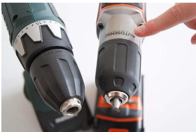
**Fluch oder Segen:** Beim Black+Decker kann das Drehmoment nicht manuell eingestellt werden. Die Autosense-Technik soll laut Hersteller Schrauben automatisch plan einschrauben. In der Praxis besteht allerdings die Gefahr, die Schrauben zu überdrehen.
