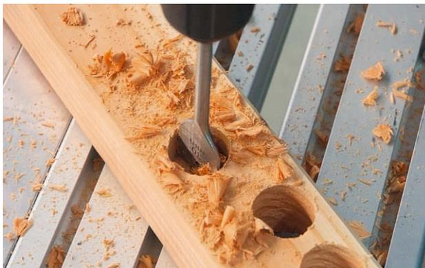
**Beim Bohrtest** mit einem 30-mm-Flachbohrer in Douglasienholz gaben sich die Geräte des Testfelds erwartungsgemäß keine Blöße. Lediglich die Metabo zeigte hier eine minimal schwächere Performance.
