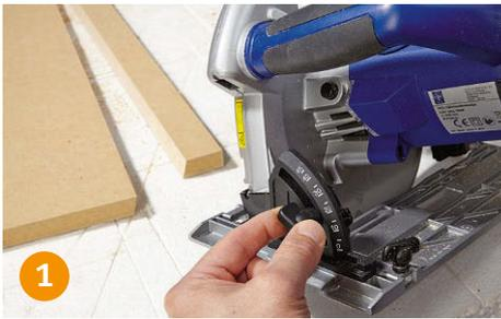
**1** Die Rückenlehne wird später im 15-Grad-Winkel hinten am Korpus sitzen. Dafür die Kreissäge entsprechend abwinkeln.
