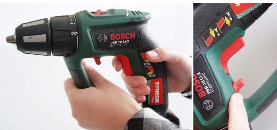
**Griff und Umschalter:** Als einziges Gerät im Testfeld fiel das von Bosch mit einem Zweigriff und einer ungewöhnlichen Anordnung des Drehrichtungsumschalters auf. Da Geräteachse und Griffmulde auf einer Achse liegen, soll sich die Kraft aus Arm und Hand optimal übertragen. Im Praxistest schnitt die Griffform befriedigend ab, der Umschalter gut.
