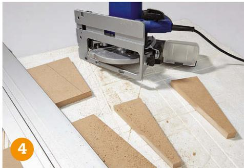
**4** Als Unterlage für die Schnitte mit der Kreissäge bietet sich immer ein großes (und genügend starkes) Stück Styropor an.
