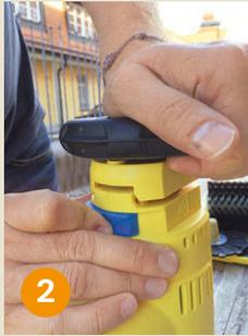
**2** Ziehen Sie den blauen Rastverschluss in Pfeilrichtung zum Entriegeln und nehmen Sie die Bürsten-/oder Radbefestigung ab. Diesen Vorgang auf beiden Seiten durchführen!
