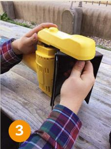
**3** Beim Einsetzen der Tauschbürste auf der Seite mit dem Zahnradgewinde entweder an der Bürstenachse oder am Fugenrad drehen, bis die Zahnräder einrasten, dann Bürste bzw. zweites Rad einsetzen, ...
