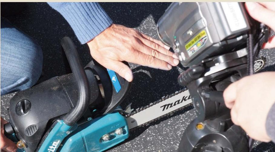
Achtung, ... Jagd auf Temposünder! Die **Funktion der Kettenbremse** überprüften die Tester mithilfe einer Hochgeschwindigkeitskamera. Sie zeichnete auf, wie schnell die Kettensäge die rotierende Kette aus dem Vollgas/-strom zum Stehen bringt, nachdem die **Sicherheitsschaltung**
