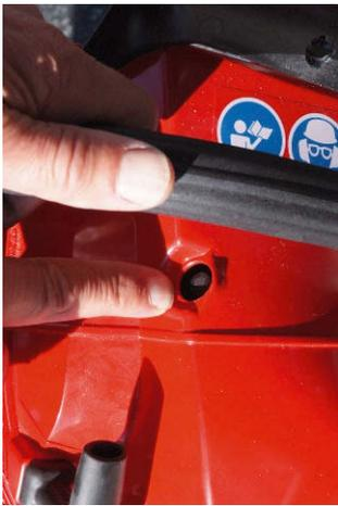
**Mit deutlich weniger Kraft** lässt sich die Solo dank eines Dekompressionsventils starten. Der Knopf liegt gut erreichbar unterhalb des Quergriffs.
