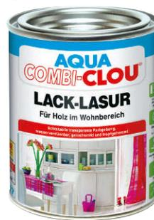
Wachslasur verwenden. Die trockene Holzfläche mit Körnung 180 schleifen, damit die Lasur gut einziehen kann. Bei Renovierung den Altanstrich nur anschleifen, dann die Lasur ohne großen Druck längs in Holzstrukturrichtung auftragen und gleichmäßig verteilen. Nach Trocknung bei Bedarf die Oberfläche mit Körnung 240 glatt schleifen, entstauben und die Lasur nochmals auftragen. Achtung: Der gleiche Lasur-Farbtone führt bei verschiedenen Hölzern zu unterschiedlichen Ergebnissen.
