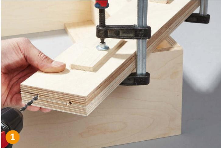
Die Einlegeböden zwingen Sie exakt übereinander und bohren dann jeweils auf den Stirnseiten zwei Löcher für die Aufnahme der Bodenträger mittig in den Spalt.
