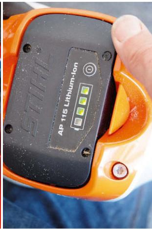
**Ein Ladestandsanzeiger** gehört bei akkubetriebenen Kettensägen leider nicht zum Standard. Die Ausnahme im Test: das Modell von Stihl.
