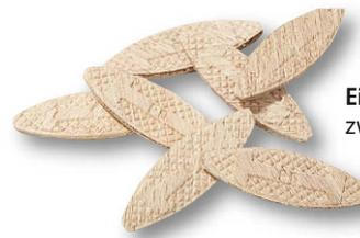
**Eine feste Holzverbindung** zwischen zwei Bauteilen erreicht man mit Flachdübeln (auch Holzlamellen genannt). Sie werden mit Holzleim in die eingefrästen Nuten der zu verbindenden Bauteile gelebt.
