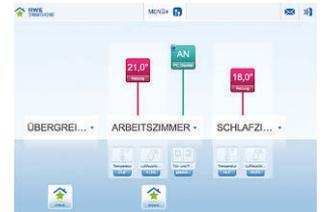
**Praktisch:** Die Funktionen werden in Räumen gruppiert. Kontaktschalter etwa regeln bei offenem Fenster automatisch die Heizung runter.
