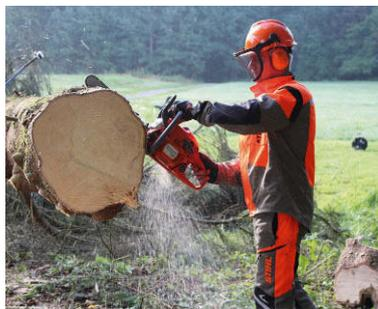
**Fest im Griff:** Bei jedem Test stand die Arbeitssicherheit an erster Stelle – nicht nur beim Sägen der Baumscheiben. Der ordentliche Spanabtrag bei der Husqvarna ist im Bild gut zu erkennen.
