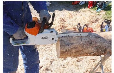
**In Längsrichtung zur Holzfaser** wird in der Praxis seltener gesägt – die Tester verlangten den Maschinen trotzdem auch hier alles ab. Die entstehenden längeren Späne machten manchen Maschinen beim Abtransport Probleme. Das sorgte für kleine Minuspunkte im Ergebnis.
