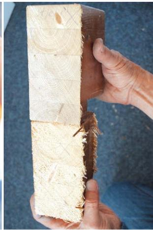
**Die Schnittbilder** hängen mit Anordnung und Form der Ketten-Schneidezähne zusammen. Oben sägte die feinere Kette des Stihl-Akkugeräts.
