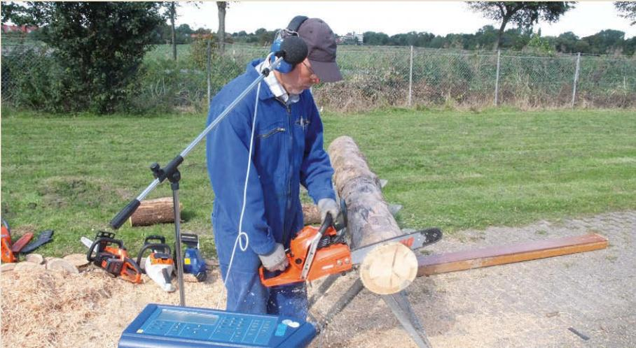
Pssst, ... Aufnahme! Aufgrund der kompakten Bauweise sind effektive(re) Schalldämpfer bei den Benzinern nicht möglich, denn die bräuchten viel Platz. Folge: Motorsägen mit Verbrennungsmotoren sind **im Lastbetrieb extrem laut**. Auf dem Testgelände des technischen Prüfinstituts PZT wurde
