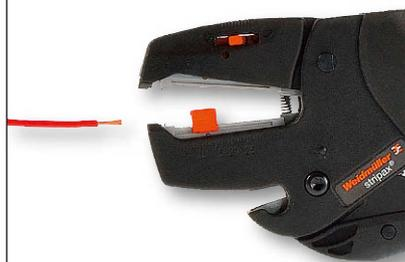
**Einmal drücken** und das Kabel ist in der eingestellten Länge (bis 25 mm) abisoliert. An der Unterseite befindet sich eine Schneidvorrichtung zum Kürzen. Die Zange hat auch eine Teilabisolierfunktion.
