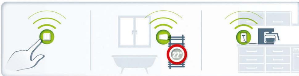
**Guten Morgen:** In einer programmierten Szene kann ein Taster eine Reihe von Vorgängen auslösen. Neben der Heizung wird hier die Kaffeemaschine gestartet. In der Zentrale ließe sich diese Befehlskette mit weiteren Aktionen koppeln – etwa das Radio starten und die Bewegungsmelder im Flur aktivieren. Die schalten dann die Beleuchtung ein, sobald der Herr des Hauses sich aus dem Schlafzimmer ins Bad schleppt.
