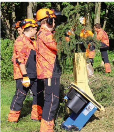
**Klassisch mit einer rotierenden Scheibe und zwei Scheidmessern** funktioniert der Biostar-Gartenhäcksler.
