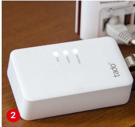
**Die zentrale Steuerungseinheit** von Tado ersetzt den Raumfühler, der bei Etagenthernen und in vielen Einfamilienhäusern im Wohnraum an der Wand hängt. Hier wird die Zentrale gemäß Anleitung über die vorhandenen Steuerungsleitungen mit der Therme verbunden. Tado steuert über 90 Prozent aller Heizungsanlagen (Herstellerinfo). Dafür misst die Zentrale die Temperatur im Raum, der somit als Referenz für die Wohnung dient. In anderen Räumen kann man die Temperatur manuell am Heizkörper anpassen.
