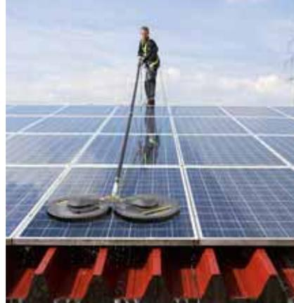
**Die Doppelbürste** iSolar 800 ist für große Anlagen gedacht. Das Modell iSolar 400 mit einem rotierenden Bürstenkopf reicht für die meisten privaten Anlagen aus
