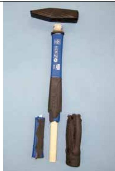
**Nach bestand-nem Test:** Erst bei 8 kN Zugkraft und damit locker über den Anforderungen knickte der Hammer aus dem Lux-Set ein. Sieht dramatisch aus, es handelt sich aber um ein sicheres Werkzeug. Bei unseren Tests geht aber das ein oder andere kaputt, weil wir die Belastungsgrenzen ganz genau bestimmen
