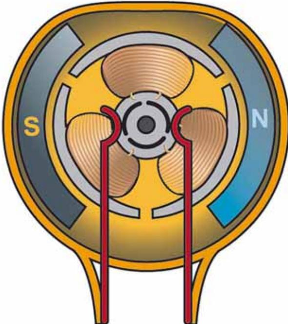
**Ein Rotor mit Dreifach-Anker** und drei kupferfarbenen Spulen. In der Mitte: der runde Kollektor (grau) mit drei stromleitenden Bürsten (schwarz, Englisch: brush). Bei jeder Drehung um ein Drittel schleift die nachfolgende Bürste abwechselnd an einer der beiden Stromleitungen (rot). Dadurch kehrt sich die Polarität in den Spulen ständig um. Folge: Die Festmagneten am Gehäuse (Stator) ziehen den kommenden Anker an und stoßen den durchgelaufenen Anker ab. Der Rotor dreht sich.
