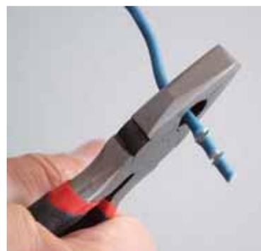
**Die Kombizange** war bei allen Sets nicht überzeugend. Nicht nur beim Lidl-Set (Bild links) sondern auch mit den Zangen von Bauhaus und Lux wurde der Test-Draht nicht sauber durchtrennt, sondern nur abgequetscht. Enttäuschend!
