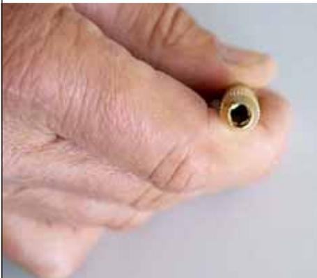
**Schaden nach Falltest:** Die massive Ausführung des Feinmechanik-Bithalters von Hama liegt gut in der Hand. Durch das hohe Eigengewicht blieb aber nach dem Falltest ein kleiner Schaden. Das Werkzeug funktioniert zwar noch, die Einführung der Bits und damit die Bedienung ist aber leider etwas erschwert
