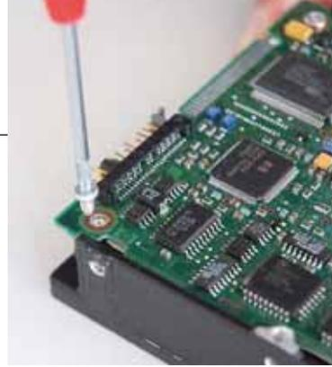
**Feinschraubendreher** von Wiha sind sehr gut für präzises Arbeiten: Die Festhaltefeder lässt keine Schraube auf die Platine fallen.
