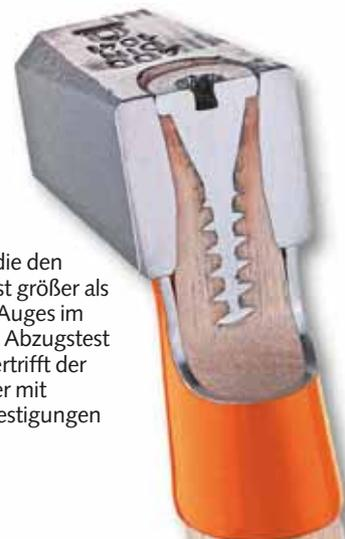
**Die Keilschraube,** die den Hammerkopf fixiert, ist größer als der Durchmesser des Auges im Innern des Kopfes. Im Abzugstest für die DIN-Norm übertrifft der Picard andere Hämmer mit normalen Ringkeilbefestigungen um ein Vielfaches.
