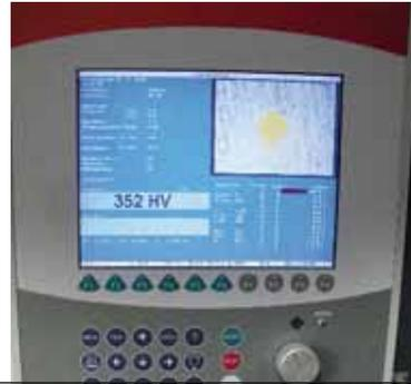
**Ein Messmikroskop** misst die Länge der Diagonalen des bleibenden Eindrucks. Daraus wird die Eindruckoberfläche errechnet, woraus sich wiederum die Materialhärte des Werkzeugs ableiten lässt
