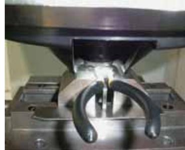
**Bei der Materialhärteprüfung** wird eine gleichseitige Diamantpyramide mit einer festgelegten Prüfkraft in das Werkzeug eingedrückt. Es entsteht ein winziger Abdruck im Material
