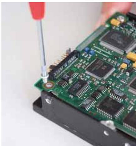
**Die Festhaltefeder** der Wiha Schraubendreher halten kleine Montageschrauben sicher fest. So können sie nicht in einem engen Schlitz oder einem Gehäuse verschwinden
