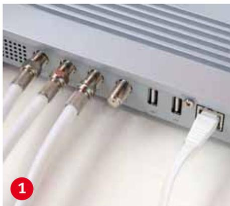
**Schließen Sie** die Koax-Eingänge an die Sat-Anlage an. Hier ist er mit drei Ausgängen eines Multischalters verbunden. Das LAN-Kabel führt zum heimischen Internetrouter.
