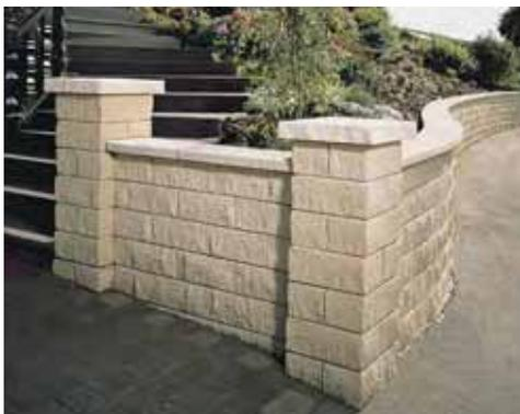
**Für den Pfosten- und Mauerbau** sind diese speziellen Betonelemente entwickelt worden. Die Außenseite ist rau und sandsteinfarben. Die Elemente haben eine Höhe von 17 cm und werden aufeinander gesteckt und mit Beton ausgegossen.
