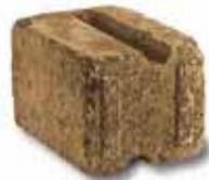
**Mauerklinker** werden aus Ton oder Lehm geformt und gebrannt. Sie sind die klassischen Mauersteine im Hausbau und finden oft Verwendung als Vormauerwerk. Auch als Pflastersteine für Wege werden sie eingesetzt.
