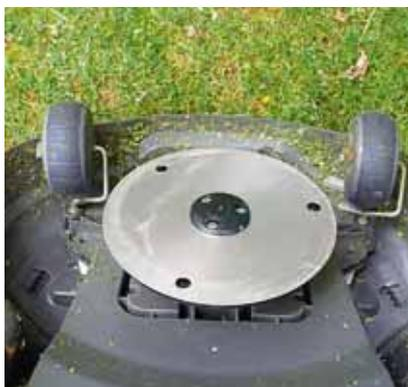
**Drei rotierende, rasiermesserscharfe** Klingen kürzen den Rasen wahlweise auf eine Höhe zwischen 20 und 60 Millimetern.
