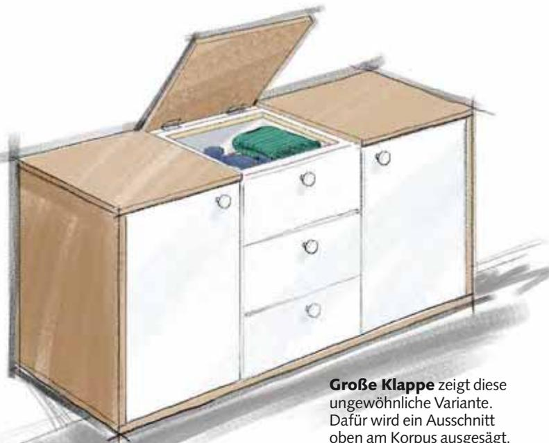
**Große Klappe** zeigt diese ungewöhnliche Variante. Dafür wird ein Ausschnitt oben am Korpus ausgesägt. Die Deckplatte wird in drei Teile zersägt, das mittlere mit Scharnieren ausgestattet
