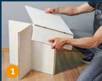
**1 Ein Hocker** oder doch ein hoher Beistelltisch? Die X-Konstruktion der hochkant stehenden Platten tr\u00e4gt locker einen Erwachsenen.
