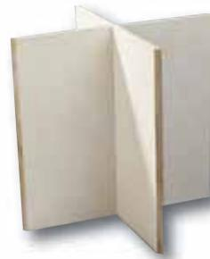
**Die X-Form** verleiht der Unterkonstruktion ohne Leim, Nägel oder Schrauben eine relativ hohe Stabilität. Allerdings nur solange die Steck-Spalten nicht breiter sind als die Stärke des hineingesteckten Brettes
