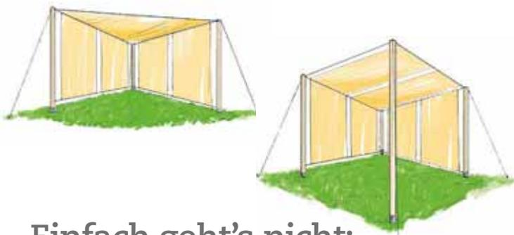
**Für den perfekten Sonnenschutz**, brauchen Sie einen vierten Pfosten, ein Drahtseil und zwei weitere Markisen (rechts). Oder Sie lassen sich ein Dreieck-Sonnensegel anfertigen, das genau in das vorgegebene Drahtseil-Dreieck passt
