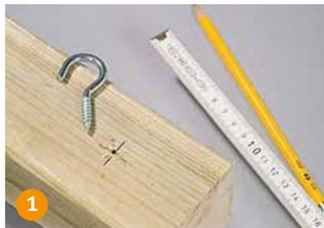
**Pfosten** kürzen, Kanten brechen, mit Bläueschutz grundieren. Haken 5 cm von der Oberkante mittig ins Holz drehen.
