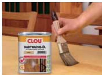
wieder rau, einfach die nächste Ölschicht auftragen, feines Schleifpapier (Körnung 240 oder 320) mit Öl befeuchten und direkt im feuchten Öl schleifen. Dann, wie gehabt, gründlich trocknen wischen. **Vorsicht:**
