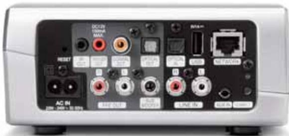
**Anschlussbox** Ein Netzwerk-Player verbindet die Stereoanlage mit dem Multiroom-System. Er gibt sein Signal über Tonausgänge an den Verstärker weiter. Sind Endstufen integriert, lassen sich Lautsprecher auch direkt anschließen. Modelle wie der Heos Link von Denon (350 Euro) haben darüber hinaus Toneingänge. So können Sie Musik vom CD-Spieler oder UKW-Radio über das Multiroom-System hören
