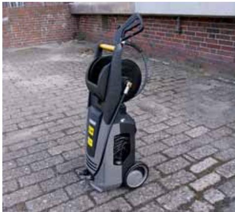
**Ordnung:** Der M 22210 von Mannesmann war das einzige Gerät im Test, das Verstaumöglichkeiten für den Schlauch und das Stromkabel bietet. Bei den anderen Modellen muss häufig der Schlauch separat gelagert oder aufgehängt werden.
