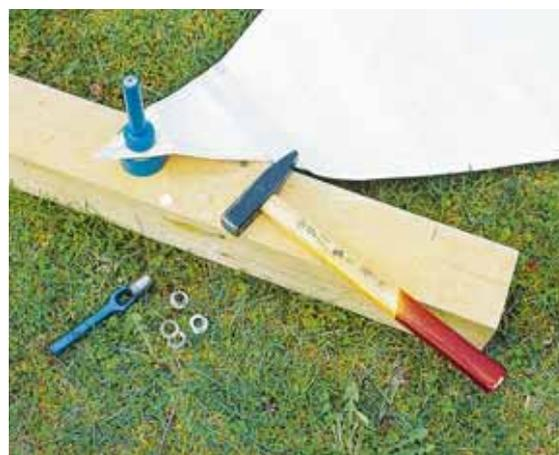
**Für große Ösen** benutzt man einen Ösenstanzer, für die Löcher nimmt man ein Locheisen.
