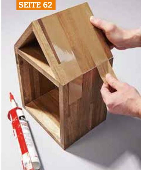
**Ohne Schrauben und Dübel** wird dieses kleine Regal in Form eines Hauses aus Leimholz gefertigt. Die auf Stoß gesetzten Teile werden mit PU-Konstruktionskleber verbunden. Am Ende können die aktuellen Lieblingsbücher einziehen oder der E-Reader ...
