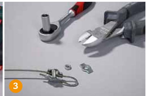
**Drahtseilenden** in die Schlaufen legen und mit Schlaufenklammern fixieren, gegebenenfalls mit Seitenschneider kürzen.
