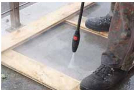
**Dreckfräse im Praxistest:** Hier mussten die Hochdruckgeräte zeigen, was sie können. Die gereinigten Flächenabschnitte wurden in trockenem Zustand verglichen.
