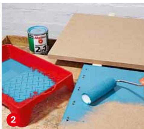
**Nach dem Entstauben** lackieren Sie die Flächen und die Kanten mit einem 2-in-1-Buntlack. So sparen Sie sich die Grundierung.
