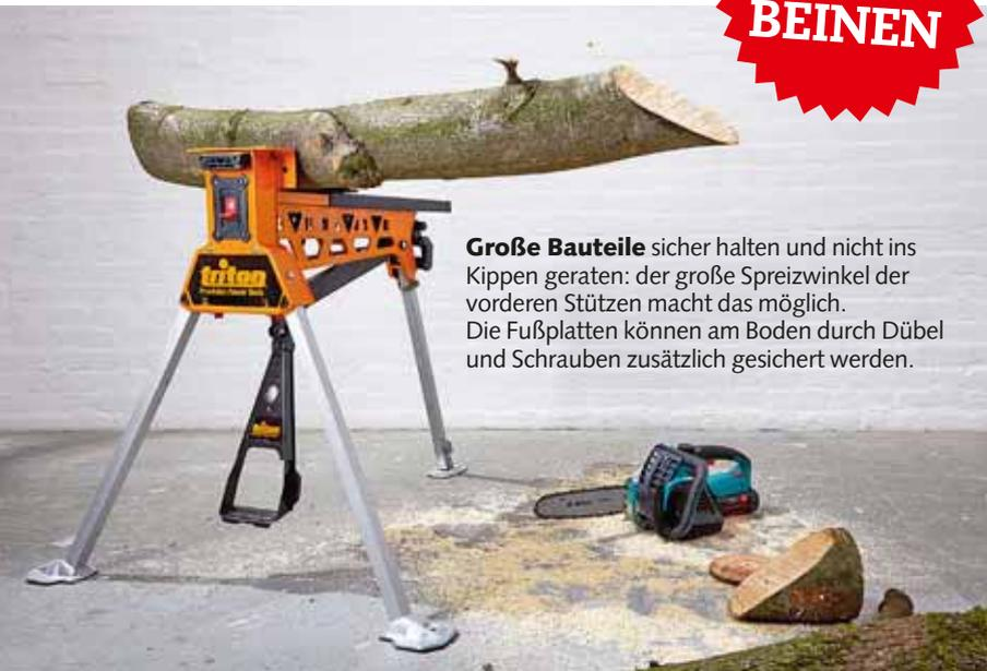
**Große Bauteile** sicher halten und nicht ins Kippen geraten: der große Spreizwinkel der vorderen Stützen macht das möglich. Die Fußplatten können am Boden durch Dübel und Schrauben zusätzlich gesichert werden.
