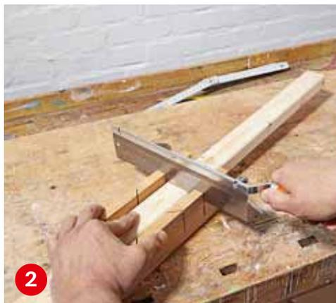
**Auf der Gehungslade** schneiden Sie die Anschlagleiste auf Länge. Die Schnittkanten sollten Sie großzügig abrunden.
