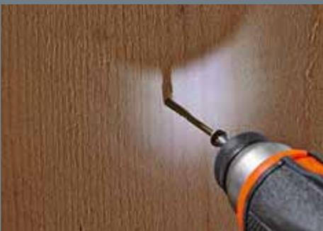
**Das Arbeitslicht** ist leider eine Schwachstelle des schwarz-orangen Schraubers: etwas schwach und diffus leuchtet es die Bohrstelle an.
