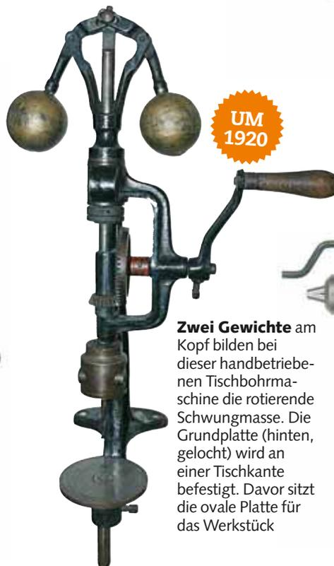
**Zwei Gewichte** am Kopf bilden bei dieser handbetriebenen Tischbohrmaschine die rotierende Schwungmasse. Die Grundplatte (hinten, gelocht) wird an einer Tischkante befestigt. Davor sitzt die ovale Platte für das Werkstück
