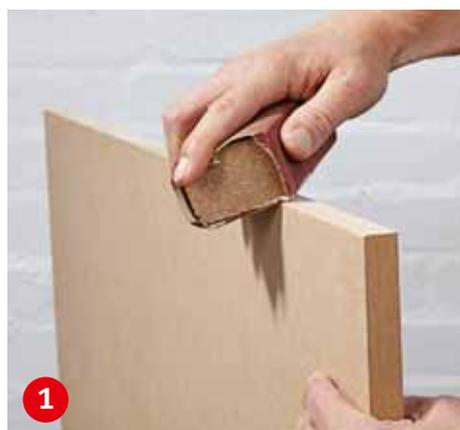
**Das Pinboard** schleifen Sie besonders an den Kanten. Brechen Sie sie mit dem Schleifklotz, damit der Lack besser haftet.
