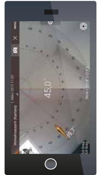
**Der Winkelmesser III** arbeitet mit einem digitalen Lot und Kamera-Abgleich. Achtung: Eine ruhige Hand ist für die genaue Messung von Vorteil.
