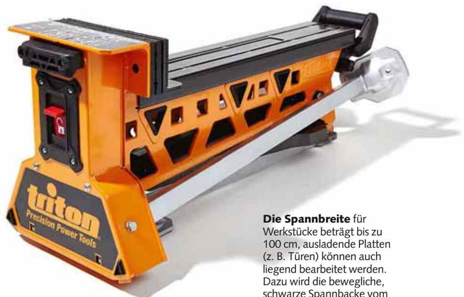
**Die Spannweite** für Werkstücke beträgt bis zu 100 cm, ausladende Platten (z. B. Türen) können auch liegend bearbeitet werden. Dazu wird die bewegliche, schwarze Spannbacke vom Arbeitsgestell genommen und um 180 Grad gedreht.
