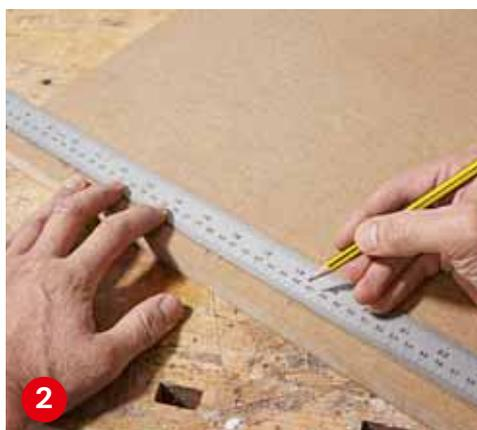
... und an der Unterkante an und verbinden Sie die Markierungen mit einem Lineal. Dabei können Sie auch gleich die Löcher anzeichnen.
