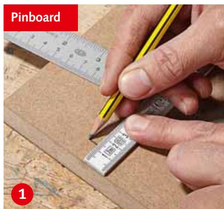
**Die Lochreihe** im Pinboard verläuft 15 mm von der Kante entfernt. Zeichnen Sie sich den Abstand an der Oberkante ...
