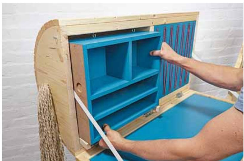
**Setzen Sie den Korpus** unten auf 25 mm dicke Zulagen, damit die Schraubhaken für das Gummiseil Platz haben. Fixiert wird er mit Schrauben in den Seiten.
