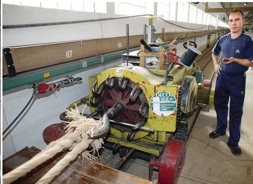
**Drei Litzen** sind auf den Haupthaken des sogenannten Austreibwagens gesteckt. Der verdreht sie mit seiner rotierenden Hakenscheibe und fährt dabei auf Schienen die Reeperbahn hinab
