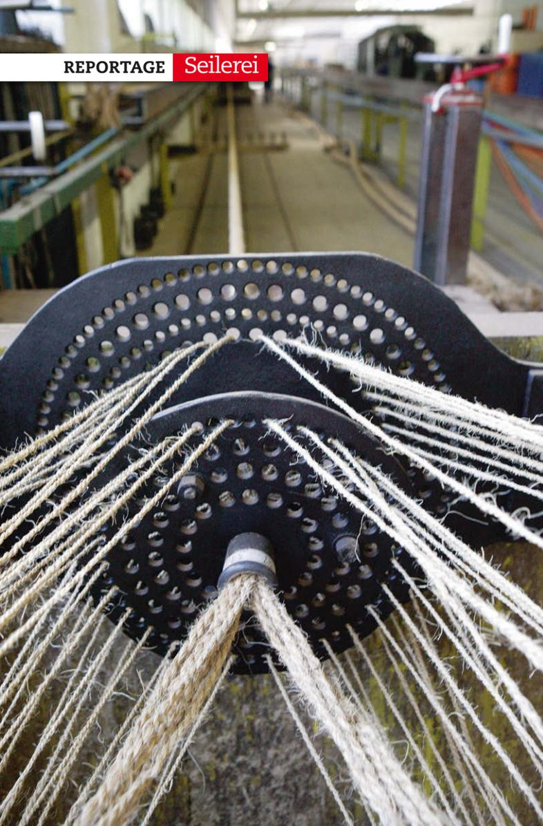
**Das eiserne Kranzbrett** führt alle Garnenden zusammen. Auf der anderen Seite werden sie auf dem Haken des (später) rotierenden Austreibwagens verknötet. Der fährt anschließend in die Tiefe der Halle
