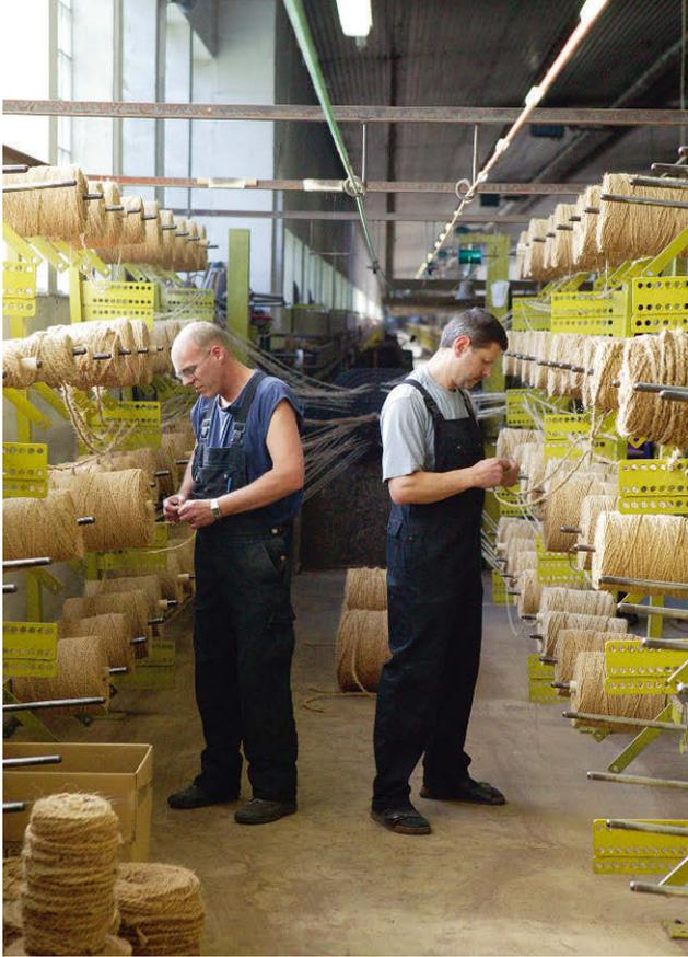
**Die Zuführung** zum Kranzbrett (im Hintergrund) erfordert Planung und Platz. Bis zu 80 Rollen (hier: Kokosgarn) können parallel von den Ablaufgestellen zur Reeperbahn geführt werden
