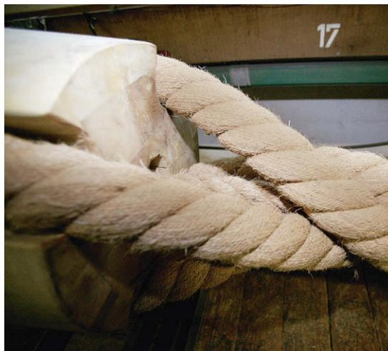
**Eine Holzlehre** wird zwischen vier der jeweils acht Zentimeter starken Kardeele platziert. In der Mitte verläuft die Seele (gut im Foto unten zu erkennen). Die Kardeele werden zu einem starken Seil verdreht, der Seiler sagt: Das Tauwerk wird „geschlagen“
