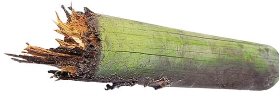
**Wie lange ein Holzelement** durchhält, hängt von der Beschaffenheit des Erdbodens ab. Steht der Holzkörper in sandigem Boden, so kann er zehn bis 15 Jahre halten. Ist der Boden lehmig, kann er schon nach fünf Jahren durchrotten.
