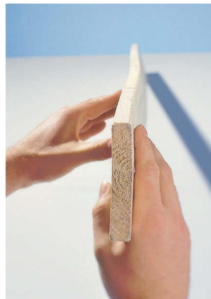
**Der prüfende Blick:** Wenn Sie an der schmalen Kante entlangsehen, werden Sie die Krümmung erkennen
