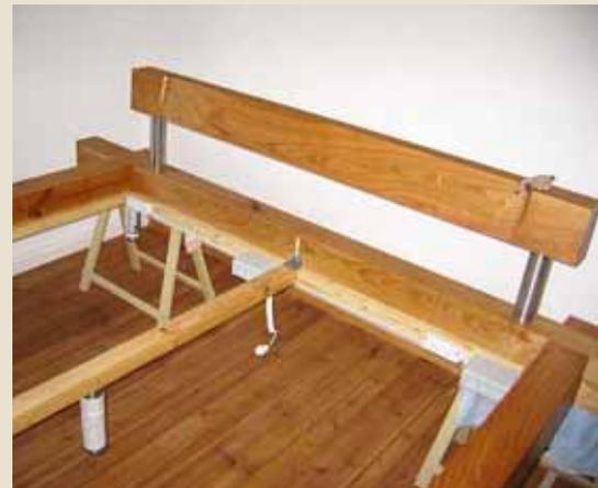
**Die zwei** V2A-Rohre am Kopfbalken wurden mit einem Wagenheber eingepresst
