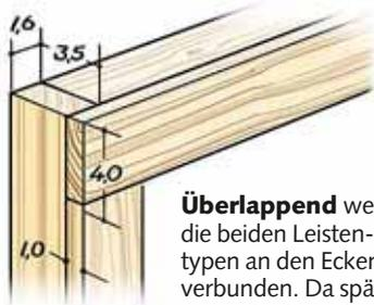
**Überlappend** werden die beiden Leistentypen an den Ecken verbunden. Da später gespachtelt wird, können Sie kleine Nägel verwenden
