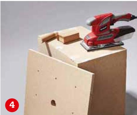
**Per Schwingschleifer** schleifen Sie alle Spachtelstellen und die Kanten Ihrer Boxen. 120er-Schleifpapier verwenden.
