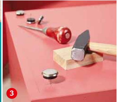
**Unter die Boxen** montieren Sie Metallgleiter (für Teppichböden). Die Nagellöcher leicht vorbohren oder ankönnen.
