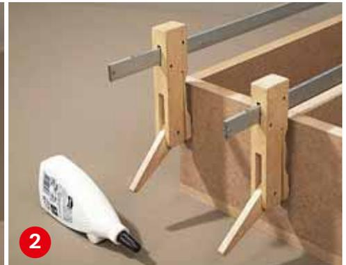
**Verleimen** Sie die Platten mit wasserfestem Holzleim und zwingen Sie sie zusammen, bis der Leim vollständig getrocknet ist.
