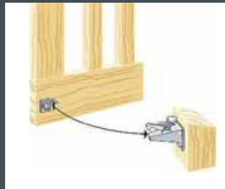
**Torfeststeller** (hier Seitenmontage, gibt es auch für Bodenmontage) mit Schnäpper und Riegelschleufe zur Arretierung.
