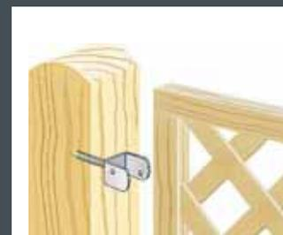
**Flechtzaunbeschläge** gibt es ein- und doppeltaschig. Sie werden mittels angeschweißter Schraube im Holz verankert.
