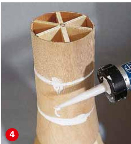
**4 Die weiteren Wandungen** montieren Sie auf die gleiche Weise. Die 2 mm breiten Fugen spritzen Sie mit Acrylmasse aus.
