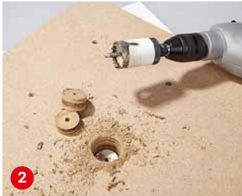
**Mit einer 40er-Lochsäge** bohren Sie ein mittig platziertes Griffloch durch beide Deckelplatten hindurch.
