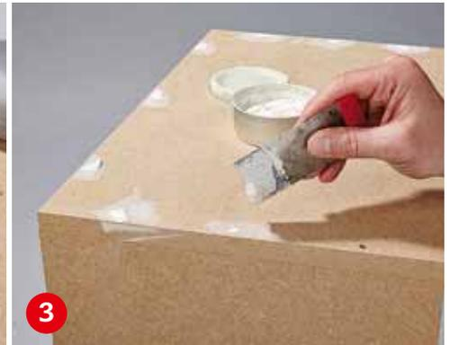
**Mit Lackspachtel** alle Schraublöcher verschließen. Nach dem Trocknen Überstände abstoßen, ein zweites Mal spachteln.
