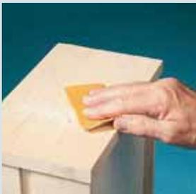
**Feines Schleifpapier** (120er bis 150er) reicht aus, um die Fasern zu brechen. Grundsätzlich in Maserrichtung schleifen und Kanten nicht vergessen
