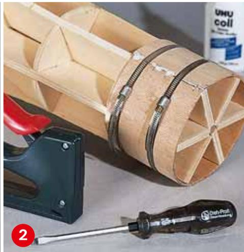
**2 Die zweite Schicht** des Sperrholzes leimen und fixieren Sie auf der ersten. Tackerklammern sorgen für zusätzlichen Halt.
