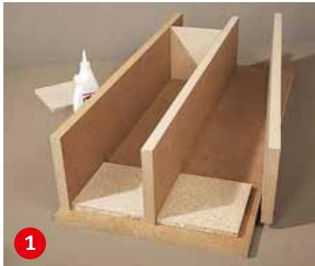
**Arbeiten** Sie mit passend zugesägten Abstandhaltern. So haben Sie beim fummeligen Verleimen beide Hände frei.
