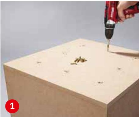
**Mit insgesamt acht Schrauben** verbinden Sie die beiden Deckelteile miteinander. Schrauben gleichmäßig anordnen.
