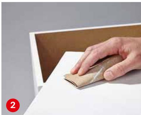
**Den Zwischenschliff** führen Sie mit 240er-Schleifpapier aus, um die Fläche für die Lackierung vorzubereiten.
