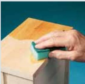
**Durch Wässern** der Oberflächen werden diese staubfrei und später glatt. Mit nassem Schwamm gründlich abreiben und trocknen lassen
