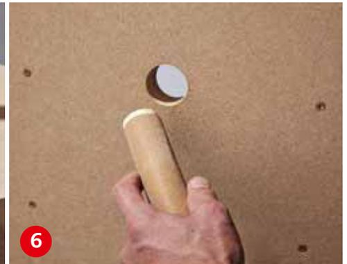
**Für das Griffloch** wickeln Sie das Schleifpapier um ein Stück Rundholz. Auch hier die Kanten großzügig brechen.
