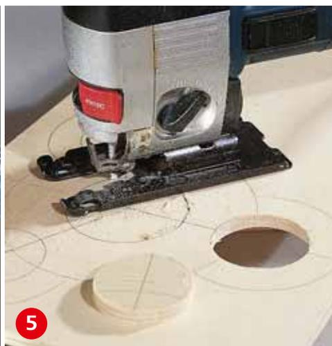
**5 Die Aussichtsplattform** zeichnen Sie sich auf eine Platte auf und schneiden sie per Stichsäge aus. Den Pendelhub an der Säge ausschalten.
