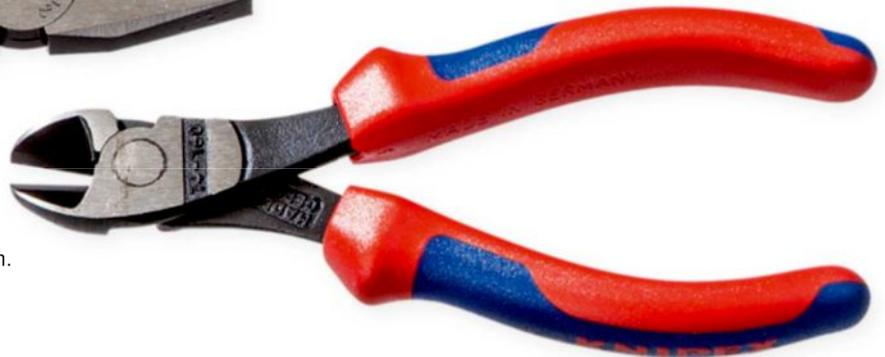
**Scharfschnitt.** Der Seitenschneider soll Kabel, Leitungen oder Drahte von unterschiedlicher Härte und Dicke durchtrennen. Dies kann er nur gut ausführen, wenn die Schneiden exakt zueinander stehen.
