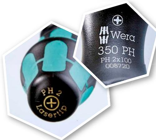
**Griffkennzeichnung.** Bei guten Schraubendrehern sind Größe und Antriebs-system aufgedruckt. PH 2 x 100 bedeutet: Spitze als Phillips-Recess-Spitze ausgeformt bei einer Klingenslänge von 100 mm. PH = Phillips-Recess PZ = Pozidriv TX = Torx
