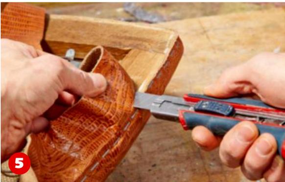
**5 Säume säubern.** Nachdem der Lederbezug am Rahmen befestigt ist, wird das überstehende Material mit einem scharfen Cuttermesser entfernt. Kantenbündig schneiden, damit der Rahmen ohne zu wackeln in der Zarge liegt.
