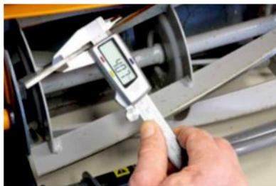
**Scharfe Klinge, dickes Blech.** Bei einem guten Spindelmäher berühren sich Ober- und Untermesser nie. Der Verschleiß ist also gering. Die fünf Messer (4mm stark) kann man nachschleifen. Fiskars bietet ein Zubehörset samt Feile an.
