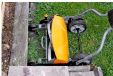
**Ran an die Kante.** Weil die Räder des Fiskars innen liegen und man das Mähwerk vor sich her schiebt, kann der StaySharp bis an die Kante mähen. Das ist gut. Schade nur, dass er konstruktionsbedingt die Maat dabei nach vorne ausspuckt ...
