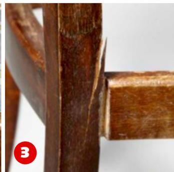
**3 Seitenzarge.** Hier hatte sich die Verleimung gelöst. Durch ständige Bewegungen der Zarge im Zapfen-loch splitterte das Stuhlbein.
