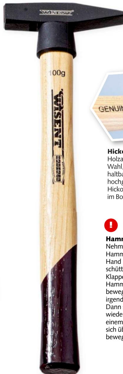
**Augenkontrolle.** Die Befestigung im sogenannten Auge des Hammerkopfes muss sichtbar sein. Dies kann eine eingedrehte Schraube oder ein eingeschlagener Metallring sein.
