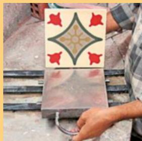
**Kraftvoll.** Mit hohem Druck wird die Fliese hydraulisch verfestigt. Nach einer Ruhezeit wird sie über einige Stunden gewässert. Dadurch, dass die Fliese nicht gebrannt wird, erhält sie ihr unverwechselbares Aussehen.
