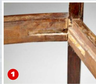
**Eckverbinder.** Einer von vieren fehlt. Er muss ersetzt werden, um den Zargenrahmen zu stabilisieren.
