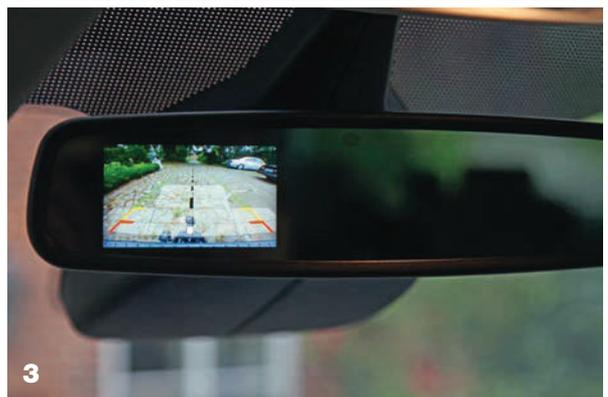
**3** Rückfahrkamera-Bildschirm im Rückspiegel: Das sehen wir gern, trotz Aufpreis. Die große Heckklappe (unten) ist wuchtig, lässt sich dank guter Dämpferunterstützung dennoch leicht öffnen, fällt aber – ganz wie bei einem Nutzfahrzeug – mit Vehemenz ins Schloss.
