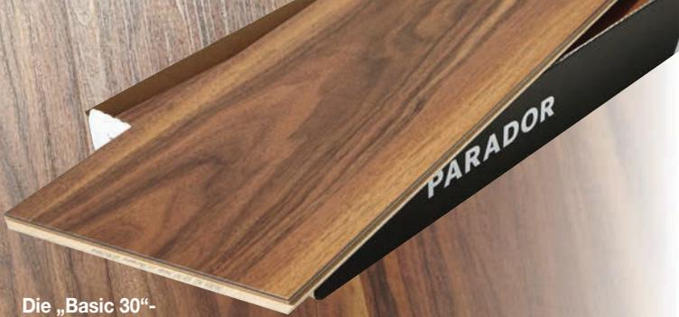
Die „Basic 30“-Dielen von Parador sind mit einer Trägerplatte aus HDF (hochdichte Faserplatte) und einer Korkschicht als Trittschalldämmung ausgestattet. Die Dielen sind knapp 1 cm stark und 120,7 x 21,6 cm groß.
