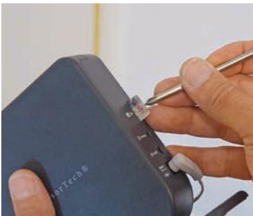
**SIM-Karte** Visortech nutzt zur Alarmübertragung das Mobilfunknetz. Hierfür muss eine SIM-Karte eingelegt werden.
