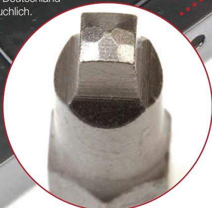
**TRI-WING**, also „Dreiflügler“ für meist industriell verwendete Spezialschrauben. Mit diesem Bit müssen kleine Reparaturen an Wecker & Co. nicht scheitern.
