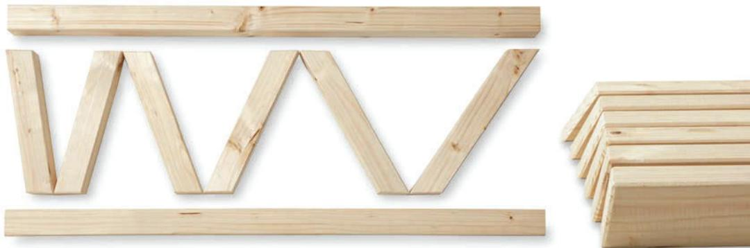
**5** Sämtliche Bauteile werden einmal ohne Leim zusammengesteckt, um zu überprüfen, ob alles perfekt zueinanderpasst.
