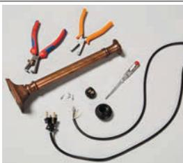
Spezialwerkzeug: Abisolierzange (rot) und Kabelendhülsenzange (orange) helfen bei einer korrekten Verkabelung.
