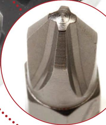
**PHILLIPS (PH)** ist sozusagen der „Ur-Kreuzschlitz“ und besteht einfach aus zwei gekreuzten Klingen. Die Angriffsfläche und damit die Kraftübertragung auf die Schraube ist deutlich höher als bei klassischen Schlitzschrauben. Man findet ihn bei vielen Schrauben mit Feingewinde.
