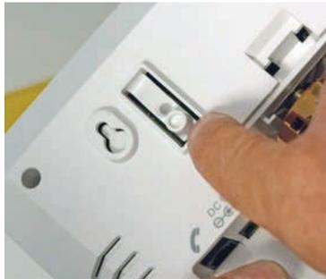
**Sicherheit** Ein Sabotageschalter löst beim gewaltsamen Entfernen von Melder und Zentrale einen Alarm aus.
