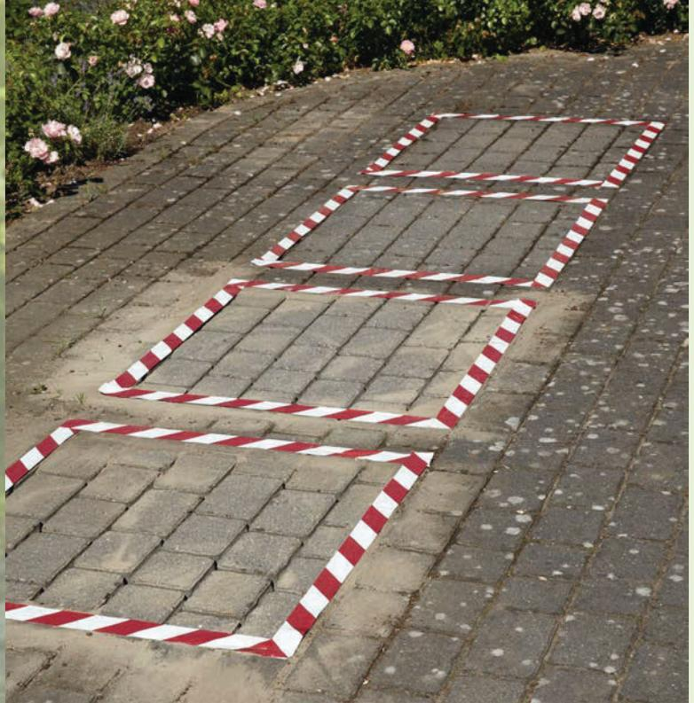
Unser Versuchsaufbau: Vier quadratische Flächen wurden auf der befallenen Terrasse mit gestreiftem Warnband abgeklebt, sodass die Ergebnisse auf einen Blick zu vergleichen sind.
