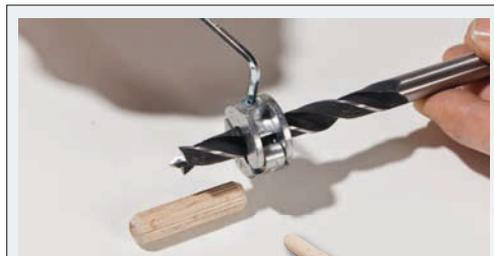
Dübelverbindungen leicht hergestellt: Mit einem Dübelset, bestehend aus Dübelmarkern in Messing (mit Markierungsdorn) und einem Bohrer mit Tiefenbegrenzer, erstellen Sie die Dübellöcher immer genau in der richtigen Tiefe! Etwa 10 Euro, von Wolfcraft.
