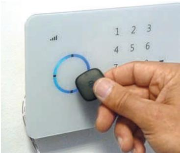
**RFID-Technik** Über einen elektromagnetischen Chip wird bei Pentatech die Alarmfunktion aktiviert und deaktiviert.
