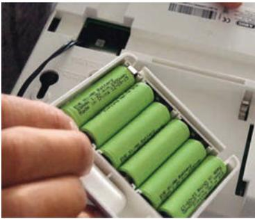
**Stromausfall** Bei allen Anlagen sichern Backupbatterien den Erhalt gespeicherter Daten auch bei Stromausfall.
