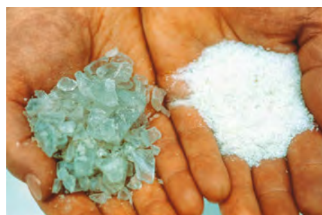
Farbgetrenntes, von Fremdstoffen befreites Glas wird in einer Mahlanlage zu feinem Pulver zerkleinert.
