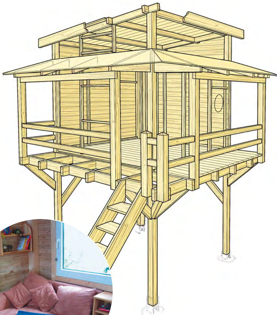
Die Veranda ist 90 cm breit und verläuft über zwei Hausseiten. Der Lastenaufzug funktioniert über einen drehbaren Galgen, der zwischen Brüstung und Dach montiert ist.
