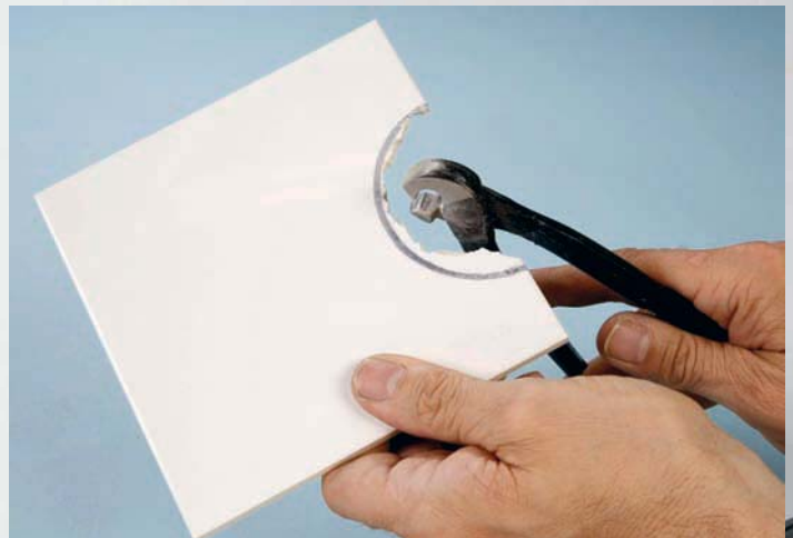
DIE KNABBERZANGE arbeitet sich langsam, aber effizient vom Fliesenrand vor. Dabei durchschneidet der scharf geschliffene obere Teil der Zange die Glasur.
