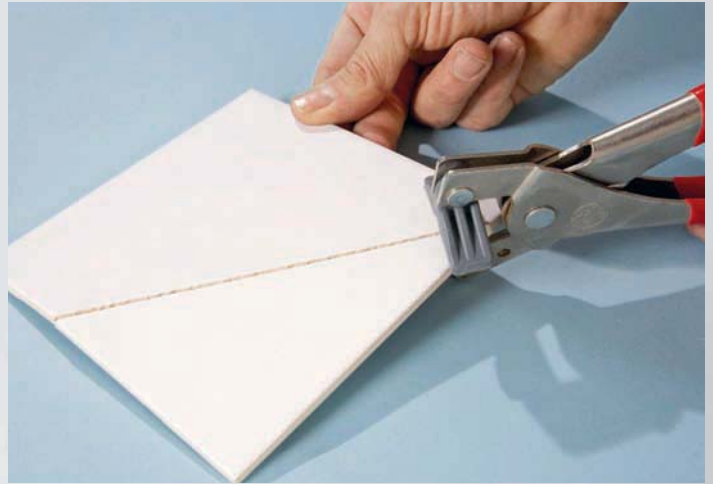
DIE BRECHZANGE wird dann zusätzlich noch bei der Bearbeitung per Hand benötigt. Sie muss auf der Risslinie angesetzt werden, damit die Fliese durch den Druck des abgewinkelten Oberteils bricht.
