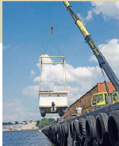
Wasserung statt Stapellauf: Leichte Schiffe wie das Hausboot, zur Taufzeit gut 5 t schwer, kommen mit Hilfe eines Krans zu Wasser.
