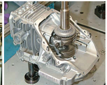
Kurbelwelle und Schwungrad folgen erst nach dem Kolben.
