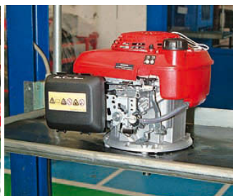
Fertig und erkannt per Strichcode, Motor auf dem Weg zum Prüfstand.
