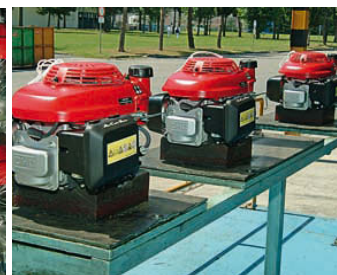
Kontrolle ist Pflicht: Aus jeder Tranche drei Motoren zum Prüfstand.
