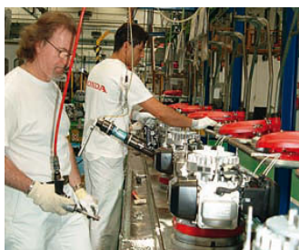
Endmontage mit Gehäusedeckel und Betriebsstoffen für den Testlauf.
