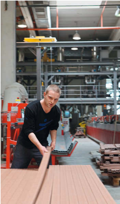
Fertig. Das unspektakuläre Ende der Fertigungsstraße: Die immer noch warmen Dielen laufen auf eine Palette.
