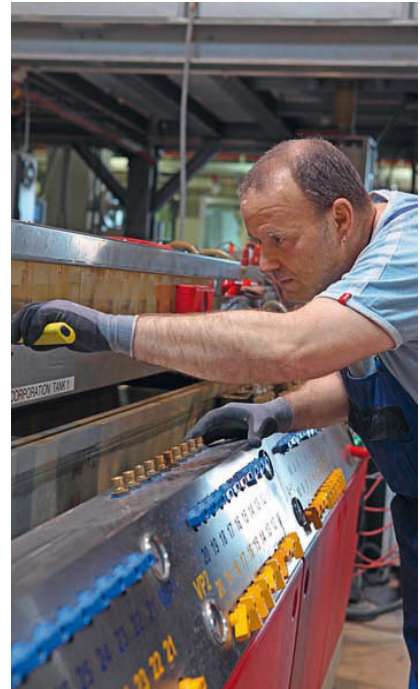
Extrusion. Hier wird das Profil geformt. Das Wasser, das zur Kühlung dient, wird aufbereitet und wiederverwendet.
