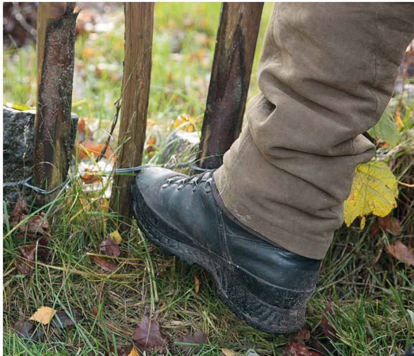
Test: Wo ein Fuß nicht durchpasst, hat auch ein Wildschweinerüssel keine Chance; jedenfalls wenn der Zaun tief im Boden verankert ist, einen massiven Querschnitt hat und aus Hartholz (Eiche) gebaut ist. Ein einfacher Maschendrahtzaun, der gerade bis zum Boden hinunter reicht, genügt nicht. Kommt der Rüssel erst bis Augenhöhe unter den Zaun, ist der Weg fürs Wildschwein frei.
