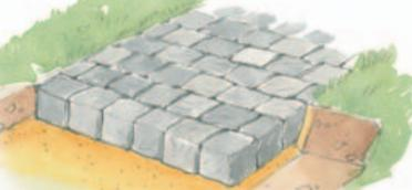
**Verzahnte Fugen** Soll die Fläche auch befahren werden (Aufsitzmäher, Auto), muss eine größere Verbundwirkung erreicht werden. Verlegen Sie die Steine so, dass die Fugen nicht durchlaufen.
