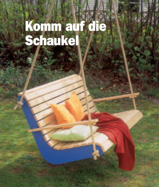
**8** Die Sitzlattung aus Eichenholz darf nicht scharfkantig sein. Deshalb sollten alle Kanten mit der Oberfräse mit einem 5-mm-Rundungsfräser bearbeitet werden.
