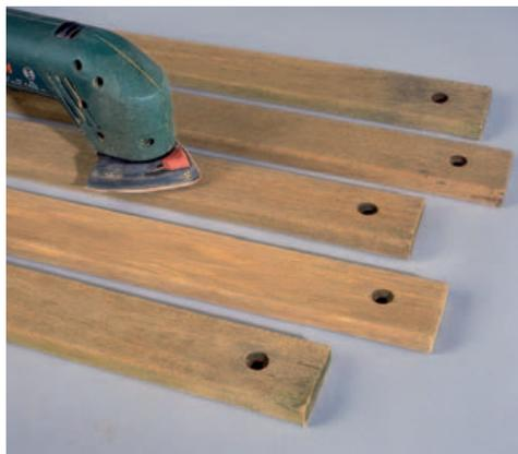
**Nach dem Trocknen des Holzes** haben sich die Holzfasern aufgestellt, und die Oberfläche fühlt sich rau an. Also wird mit 120er-Schleifpapier gründlich geschliffen und so das Holz wieder glatt.
