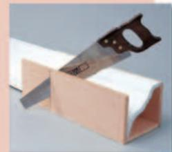
Werkstück auf, das rechtwinklig gekürzt beziehungsweise mit einer Gehrung versehen werden soll. Die Gehrungslade ist geeignet für Holzleisten aller Art sowie für Stuckprofile aus Gips oder Hartschaum.
