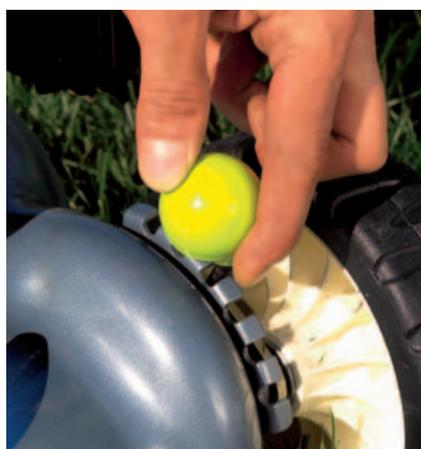
Ein griffiger Hebel erleichtert die Höheneinstellung beim Honda Isy. Sie muss jedoch für jede Achse getrennt eingestellt werden. Die Stufen sind leider nicht gekennzeichnet.
