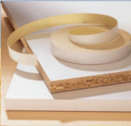
**Offene Schnittkanten** sind besonders bei Spanplatten problematisch und werden am besten mit einem Kantenumleimer verschlossen.
