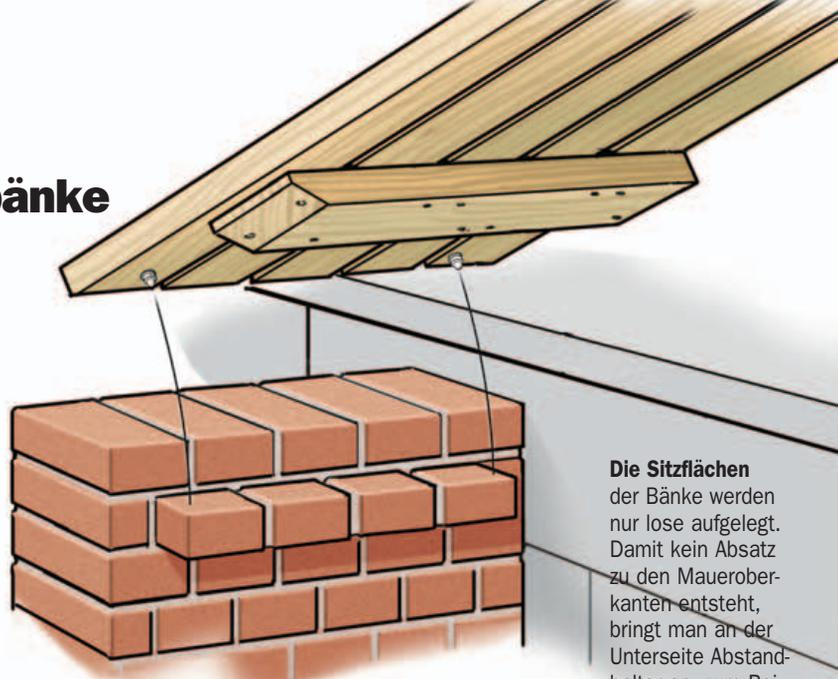
**Die Sitzflächen** der Bänke werden nur lose aufgelegt. Damit kein Absatz zu den Maueroberkanten entsteht, bringt man an der Unterseite Abstandhalter an, zum Beispiel Schrauben mit Kunststoffhaube.
