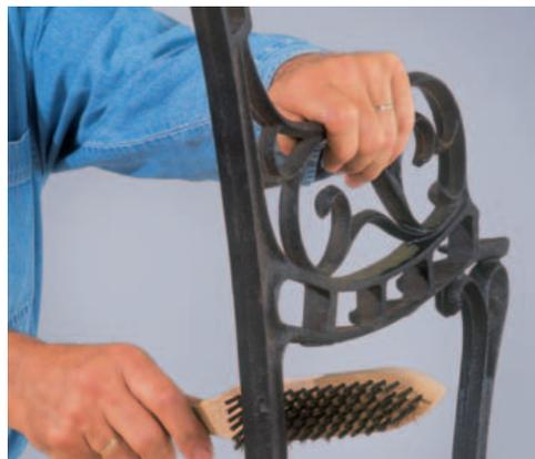
**Die gusseisernen Teile** der Bank werden rein mechanisch von Rost, Algen und alter Farbe befreit. Am besten mit einer Hand-Drahtbürste oder einer Topf-Drahtbürste für die Bohrmaschine.
