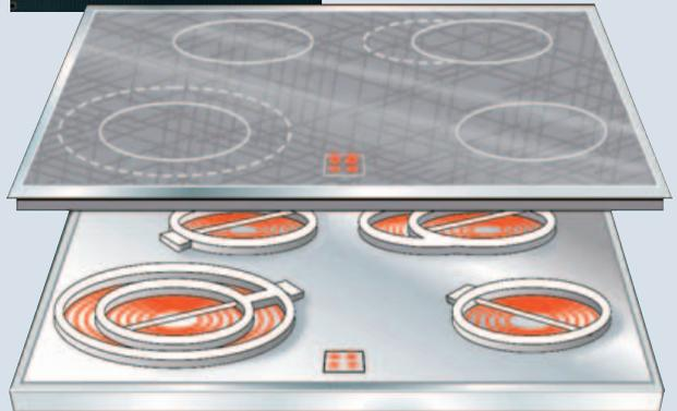
Eine Platte aus Glaskeramik bildet die Stellfläche für Töpfe und Pfannen. Unter der Platte befinden sich in einem Blechgehäuse die einzelnen Heizelemente, deren Position auf der Platte durch eine entsprechende Markierung sichtbar gemacht ist.
