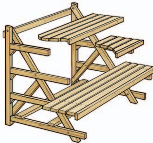
**Für die Stellage** schrauben Sie erst die beiden Seitenteile zusammen und verbinden sie dann mit den Leisten des mittleren Bodens und den unteren Streben.
