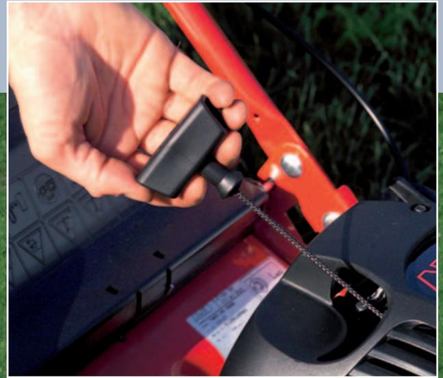
Mit dem Anwerfseil lassen sich alle Motoren der Testgeräte leicht starten. Allerdings muss man nach längerem Stehen des Motors meist mehrmals ziehen, bis er anspringt.
