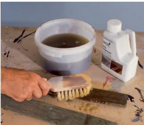
**Zunächst wird die Bank** komplett auseinandergebaut und alle Holzteile mit einem speziellen Algenentferner (zum Beispiel von Osmo) geschrubbt. Das muss meist drei- bis viermal gemacht werden.
