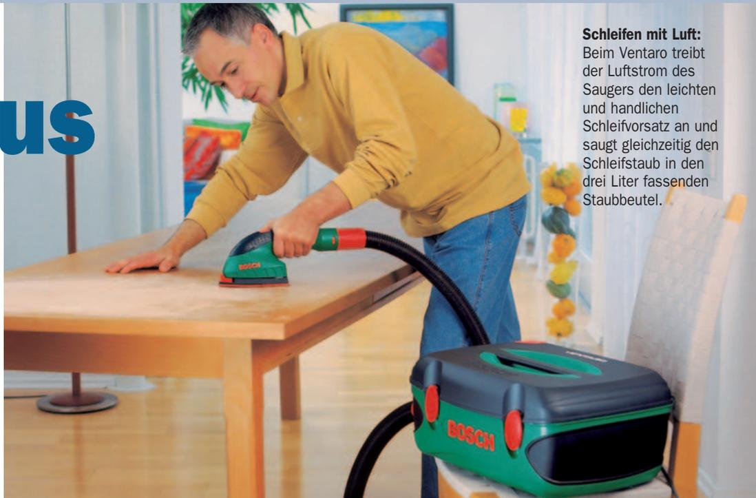
**Schleifen mit Luft:** Beim Ventaro treibt der Luftstrom des Saugers den leichten und handlichen Schleifvorsatz an und saugt gleichzeitig den Schleifstaub in den drei Liter fassenden Staubbeutel.
