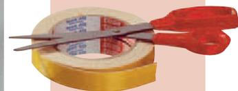
Kunststoff und Metall. Von dem beidseitig extra stark haftenden Montageband klebt man senkrecht mehrere Streifen, je nach Größe des Spiegels, auf die Rückseite. Dicke und Elastizität des Bandes gleichen kleine Unebenheiten des Untergrundes und des Objektes aus.
