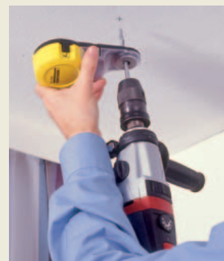
Zum Bohren in der Decke eignet sich der Kärcher-Bohrstaubfänger nicht, da der Staub dann nicht von allein in den Behälter fällt.
