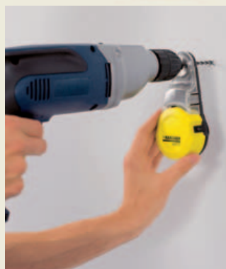
Den Bohrer an der Markierung an der Wand ansetzen. Erst danach kann der Bohrstaubfänger an die Wand gedrückt werden.
