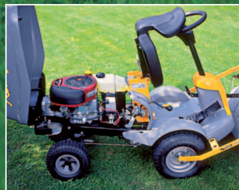
Gut zugänglich ist der Motor nach Vorklappen des Sitzes und Öffnen der großen Motorhaube. Auch der Tank befindet sich unter der Haube.
