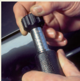
An der Skala lässt sich das gewünschte Drehmoment genau einstellen.
