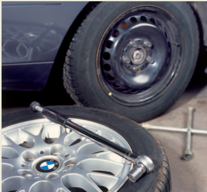
Drehmomentschlüssel sind Messwerkzeuge. Sie sollen nicht zum Lösen, sondern nur zum Anziehen der Radmuttern benutzt werden.
