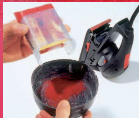
Nur einer kleiner Teil des beim Arbeiten mit dem Skil 7350 anfallenden Schleifstaubs sammelt sich im Staubbehälter aus Kunststoff.
