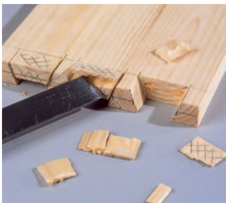
9 Das Brett umdrehen und die gleiche Arbeit von der anderen Seite ausführen, damit das Holz an sichtbarer Seite nicht ausreißt.
