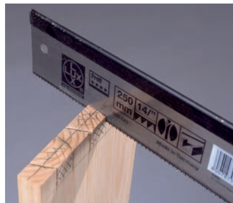
6 Mit einer Feinsäge werden die Zinken ausgesägt. Spannen Sie das Brett für diese Tätigkeit fest oder in eine Hobelbank ein.
