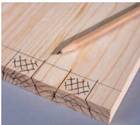
5 Markieren Sie die Teile, die Sie aussägen wollen deutlich und lassen Sie beim Aussägen der Zinken die Bleistiftrisse stehen.
