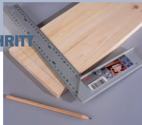
1 Zeichnen Sie mit einem Tischlerwinkel und einem Bleistift beidseitig die Brettdicke auf das Ende des ersten Werkstückes.
