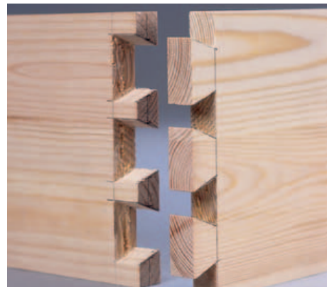
13 Die fertige Schwalbenschwanzzinkung kann nun zusammengesetzt und mit etwas Holzleim dauerhaft verbunden werden.
