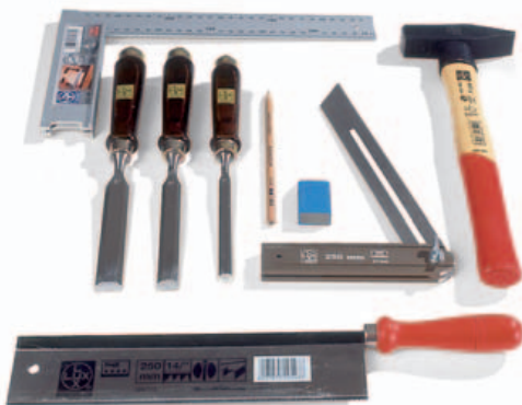
Das richtige Werkzeug: Winkel, Stechbeitel, Bleistift, Radiergummi, verstellbare Schmiege, Hammer und Feinsäge. Ein Streichmaß ist hilfreich, jedoch kein Muss.
