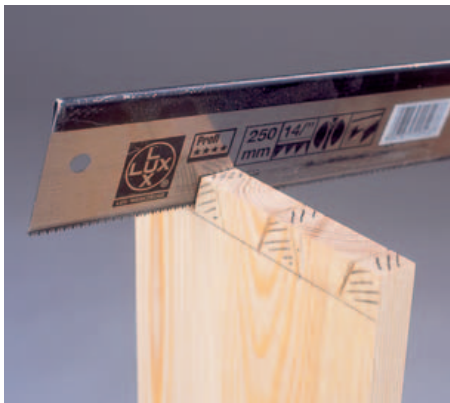
12 Die Schwalbenschwänze werden auf Rissmitte mit der Feinsäge eingesägt und wie die Zinken mit dem Stecheisen ausgestochen.
