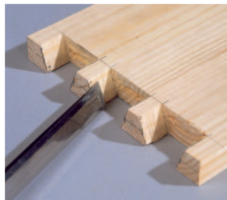
10 Unsaubere Bereiche, sei es vom Sägen oder vom Abstechen, werden mit dem Stechbeitel vorsichtig ausgeputzt.
