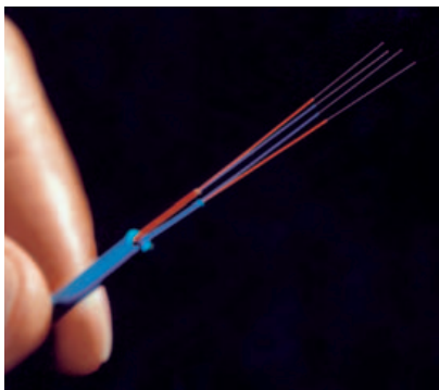
Glasfaserkabel werden künftig die üblichen Kupferkabel ersetzen und Daten noch schneller im Telefonnetz transportieren.
