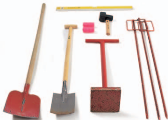
Das Werkzeug: Wasserwaage, Nylonschnur (Mauerschnur), Verlegehammer mit Gummikappe, Schaufel, Spaten, Verdichter und mehrere Sticken.
