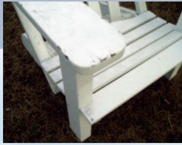
Schon kleinste Beschädigungen in der Lackoberfläche lassen zerstörerische Feuchtigkeit ins Holz eindringen.
