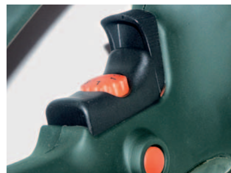
Die Schalterwippe bei der Black & Decker KR 999 steht beim Rechtslauf in mittlerer Position und wird zum Linkslauf zur Seite gedrückt.
