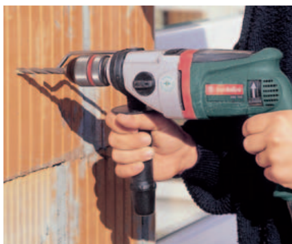
Der Zusatzhandgriff gehört bei Schlagbohrmaschinen zur Serienausstattung. Auf ihn sollte man gerade beim Bohren mit dickeren Bohrern nicht verzichten.
