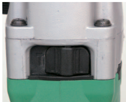
Schwarzes Loch: Die Symbole für die Stellung des Schlagwerksschalters (Hammerbohren/Bohren) sind bei der Schlagbohrmaschine von Hitachi kaum zu erkennen.
