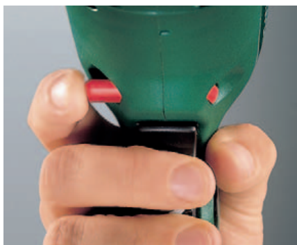
Der Schiebeschalter für die Laufrichtungsumschaltung wie hier bei Bosch ist besser zu bedienen als die sonst oft übliche Schalterwippe direkt über dem „Gas“-schalter.
