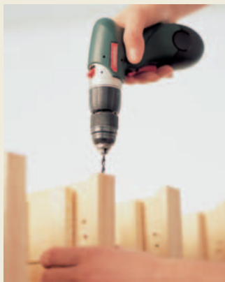
Das Bohrfutter , serienmäßig mitgeliefert, ist nur für kleinere Bohrarbeiten gedacht.
