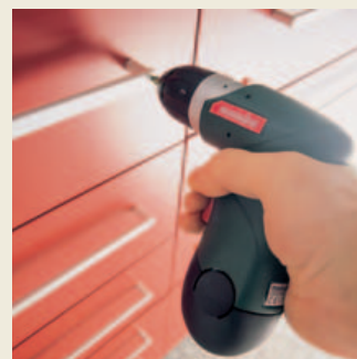
Zum gefühlvollen Schrauben lässt sich das Drehmoment des PowerMaxx' in fünf Stufen variieren.
