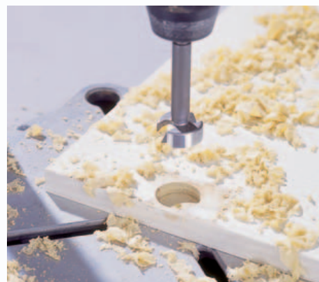
5 Mit einem Forstnerbohrer mit 35 mm Durchmesser wird nun im Bohrständer ein dem Scharniertopf entsprechendes Loch gebohrt.
