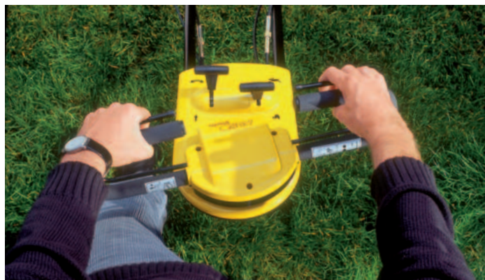
Durch Drehen des Lenkbügels wird beim Alko Vario die Vorderachse in entgegengesetzte Richtung bewegt. Ein Hebel arretiert die Lenkung.
