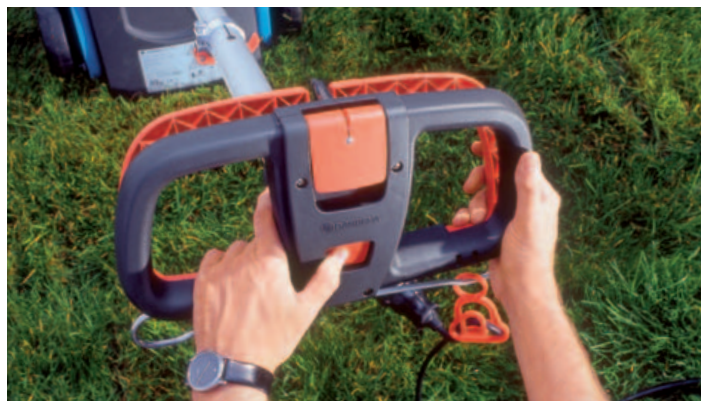
Das Cockpit: Die Starttaste startet den Elektromotor. Der aufklappbare Hebel oben am Lenkrad verriegelt die Lenkung für Geradeausfahrten.
