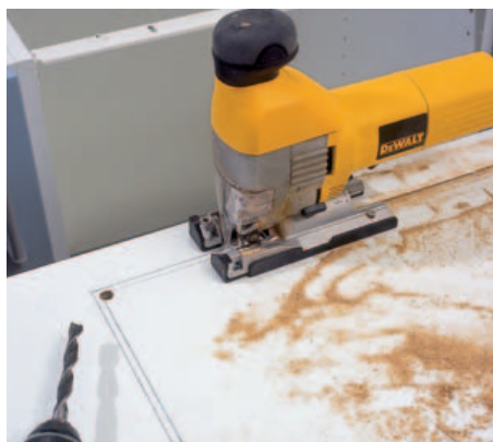
9 Mit der Elektrostichsäge wird der eingzeichnete Bereich ausgesägt. 10-mm-Löcher in den Ecken helfen, eine saubere Kurve zu sägen.
