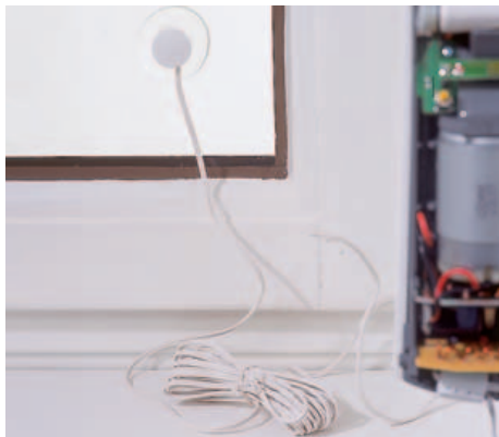
13 Zubehör: Sonnen- und Dämmerungs-Sensor. Diesen kleben Sie mit angefeuchtem Saugnapf etwa 10 cm vom unteren Fensterrand auf.
