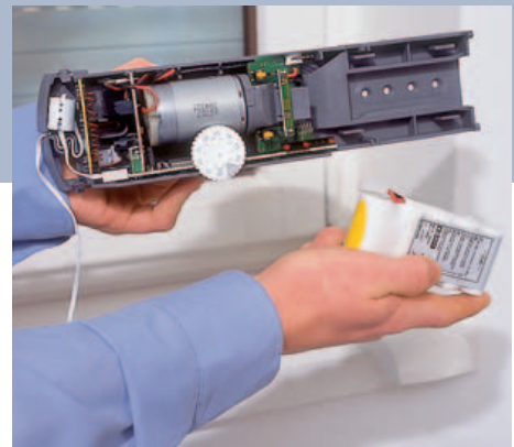
3 Gehäusedeckel abnehmen und den Akkupack einsetzen, verkabeln und ans Stromnetz anschließen (Ladezeit Minimum 12 Stunden).
