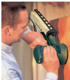
Beim Schleifen an Wänden und Decken sind die leichten Exzenterschleifer mit 125 mm großem Schleifteller im Vorteil.
