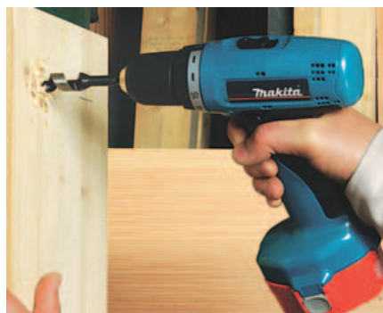
Die kleinste und handlichste Maschine, die „6280 DWAE“ von Makita, muss leider mit einem zweihüligen Bohrfutter auskommen, das umständlicher in der Bedienung ist.
