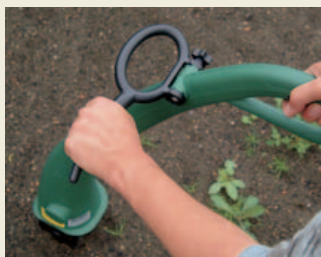
Der Handgriff ist nötig, um den „Bodenkeiler“ im Beet führen zu können. Er ist verstellbar, muss dafür aber jedes Mal komplett demontiert werden.
