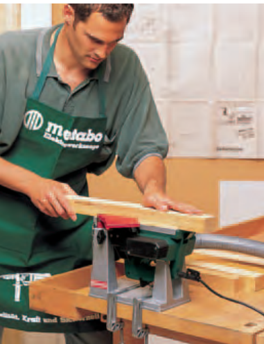
Ein Abrichttisch erlaubt das Hobeln winkeln- genauer Leisten mit dem Elektro-Handhobel.
