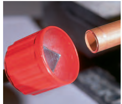
2b ...oder einem Entgrater – wie er in viele Rohrschneider bereits integriert ist –, der die Grate schnell und sauber entfernt.
