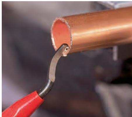
2a Um Strömungswiderstände in der Rohrleitung zu vermeiden, muss die Schnittstelle entgratet werden. Entweder mit dem Schnellentgrater...
