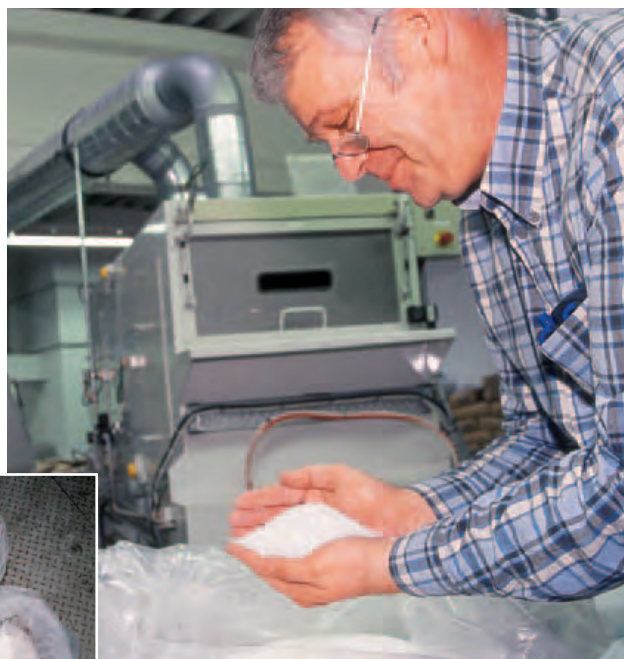
Rohstoffe (links) wie Kunststoffgranulat, Harz und Farbpulver werden zur Klebmasse verarbeitet.
