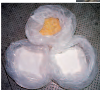
Rohstoffe (links) wie Kunststoffgranulat, Harz und Farbpulver werden zur Klebmasse verarbeitet.
