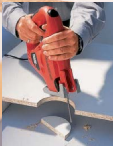
In der Stichsägeposition ist es ziemlich schwierig, die Maschine genau zu führen. Die Griffe sind zu hoch positioniert, die Auflage ist zu wackelig.
